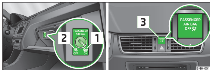
Fig. 123 Comutator cu cheie pentru airbagul frontal al pasagerului față / lampă de control pentru dezactivarea/activarea airbagului frontal al pasagerului față
