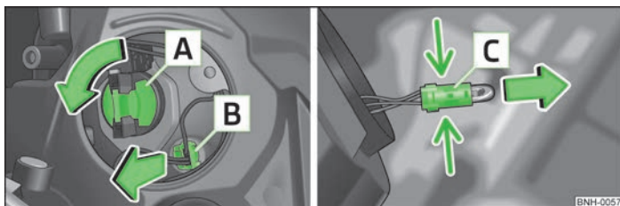
Fig. 128 Înlocuirea becului pentru lumina de drum, de zi și de poziție
