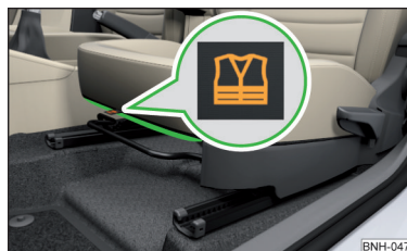
Fig. 154 Compartimentul de depozitare pentru vesta reflectorizantă
