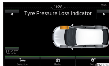
Fig. 127 Tasta pentru memorarea valorilor presiunii / exemplu de indicator de pe afișaj: sistemul atrage atenția asupra unei modificări a presiunii anvelopei din dreapta față
