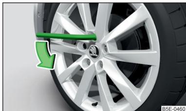
Fig. 160 Înlocuirea roții: Slăbirea șuruburilor de roată
