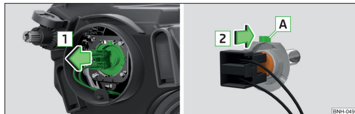
Fig. 181 Înlocuirea becului luminii de întâlnire
