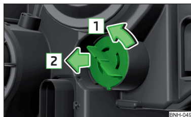
Fig. 184 Înlocuirea becului luminii de semnalizare față
