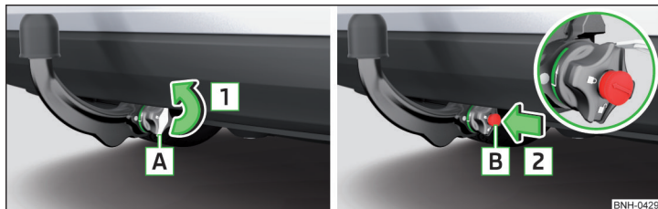
Fig. 223 Detașarea capacului de încuietoare/Introducerea cheii în încuietoare
