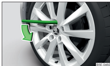
Fig. 246 Slăbirea șuruburilor de roată
