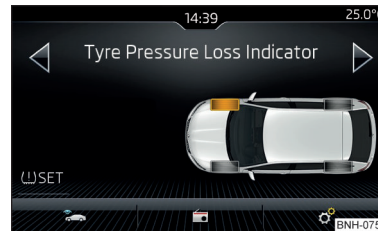
Fig. 214 Tasta pentru memorarea valorilor presiunii/exemplu de indicator de pe afișaj: sistemul atrage atenția asupra unei modificări a presiunii anvelopei din dreapta față
