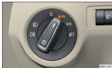
Fig. 54 Comutatorul de lumini: Poziția AUTO
