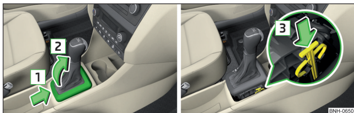
Fig. 258 Scoaterea capacului / deblocarea selectorului de viteze
