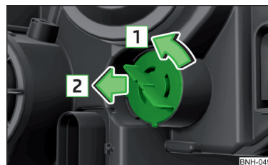
Fig. 272 Înlocuirea becului luminii de semnalizare față
