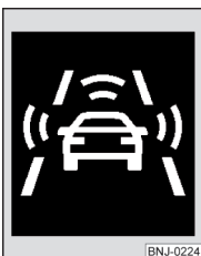
Fig. 212 Afășajul panoului de bord: Preavertizare, resp. frânare de urgență la o viteză redusă
