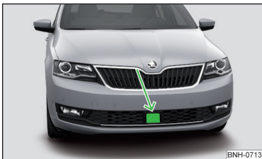
Fig. 196 Locul de montare al senzorului radar
