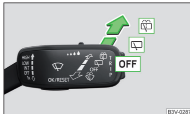
Fig. 64 Operarea instalației de ștergere și spălare a geamurilor
