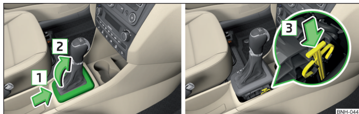
Fig. 154 Deblocarea de urgență a selectorului de viteze
