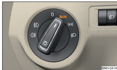
Fig. 42 Comutatorul de lumini: Poziția AUTO
