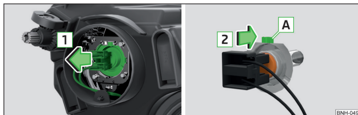
Fig. 191 Înlocuirea becului luminii de întâlnire
