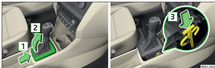
Fig. 180 Scoaterea capacului / deblocarea selectorului de viteze
