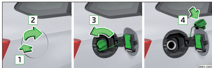
Fig. 150 Deschiderea clapetei rezervorului de combustibil/Deșurubarea bușonului rezervorului de combustibil/Introducerea bușonului rezervorului de combustibil în clapeta rezervorului de combustibil
