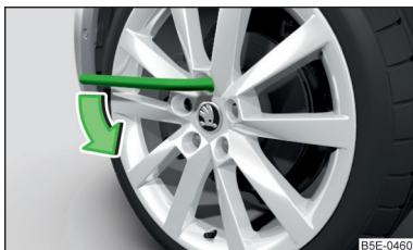
Fig. 167 Slăbirea șuruburilor de roată
