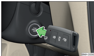
Fig. 105 Porniți motorul - apăsați butonul cu cheie.
