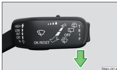
Fig. 181 Reglarea poziției de service a brațelor ștergătoarelor de parbriz
