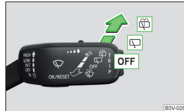
Fig. 51 Operarea instalației de ștergere și spălare a geamurilor
