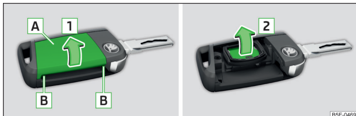
Fig. 176 Demontarea capacului / scoaterea bateriei
