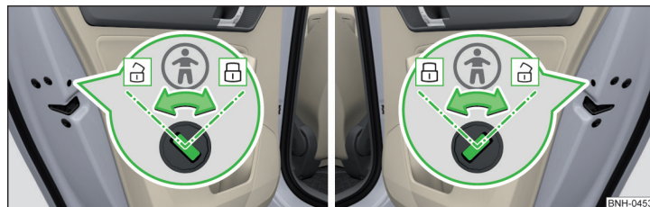
Fig. 34 Portiera spate: Activarea/dezactivarea siguranței pentru copii
