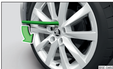
Fig. 247 Slăbirea șuruburilor de roată
