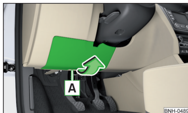
Fig. 265 Detășarea capacului panoului de siguranțe
