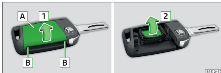
Fig. 256 Ridicarea capacului/scoaterea bateriei
