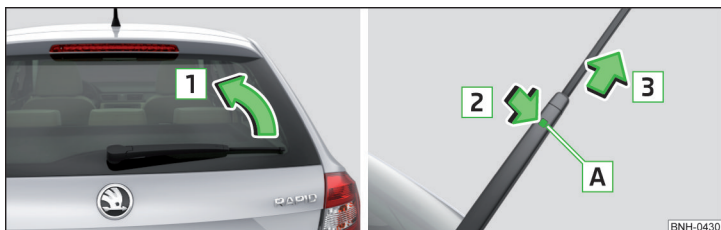
Fig. 263 Înlocuirea lamei ștergătorului de lunetă
