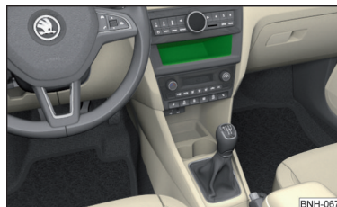
Fig. 80 Compartimentul de depozitare
