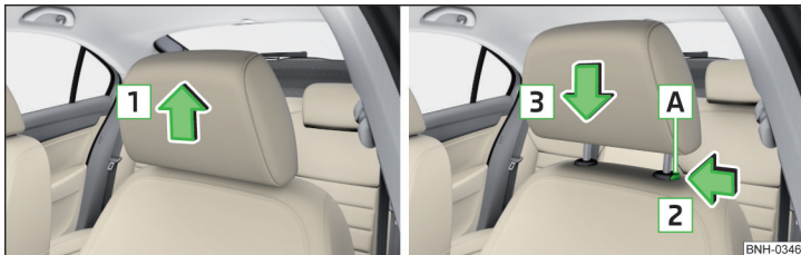
Fig. 72 Reglarea pe înălțime a tetierei
