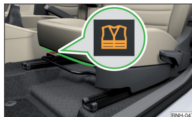
Fig. 241 Compartimentul de depozitare pentru vesta reflectorizantă
