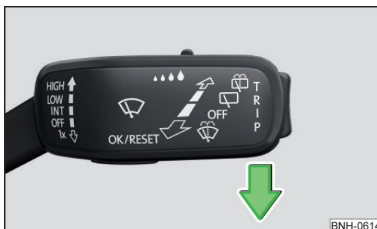
Fig. 261 Reglarea poziției de service a brațelor ștergătoarelor de parbriz
