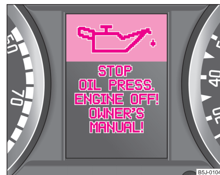
Fig. 13 Display-ul cu informații: presiunea uleiului scăzută
