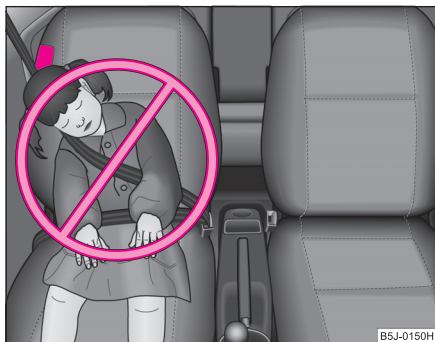
Fig. 136 Copil neasigurat corect într-o poziție incorectă - siguranța periclitată de airbag-ul lateral
