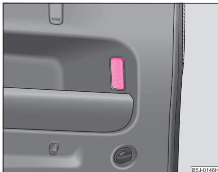
Fig. 194 Demontarea lămpii din portbagaj
