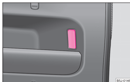
Fig. 195 Demontarea lămpii din portbagaj
