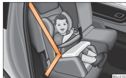
Fig. 159 Scaun cu măsura de siguranță din grupa 1 montat pe bancheta din spate, cu fața la sensul de mers.
