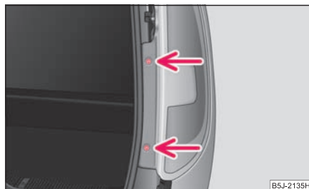
Fig. 212 Demontarea lămpii din spate
