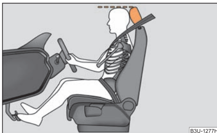
Fig. 137 Reglarea corectă a înălțimii tetierei
