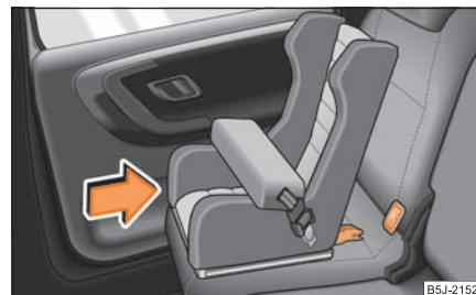
Fig. 163 Scaunul cu sistem ISOFIX se montează în dispozitive de prindere existente.
