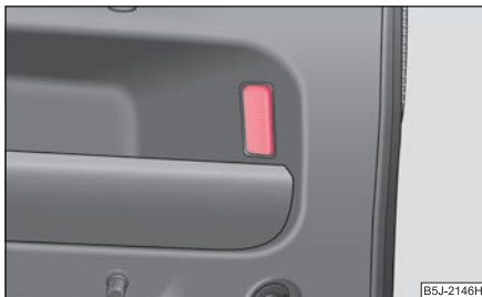
Fig. 216 Demontarea lămpii din portbagaj
