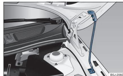
Fig. 176 Asigurarea capotei motorului cu tija de susținere
