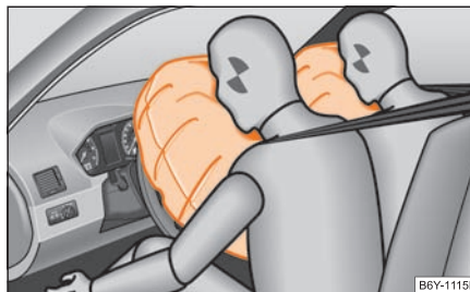
Fig. 147 Airbag umplut cu gaz
