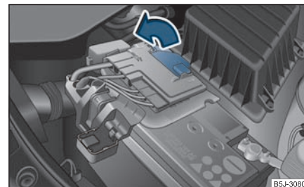
Fig. 182 Bateria: Se ridică capacul (cutie de viteze manuală)
