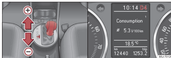
Fig. 98 Selectarea manuală a vitezelor: Selectorul de viteze / Display-ul informativ mare ▶
