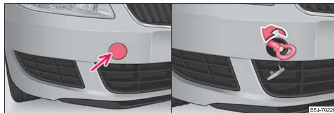
Fig. 154 Bara de protecție față: Grilajul de protecție / montarea inelului de remorcare
