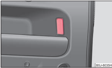
Fig. 172 Demontarea lămpii din portbagaj
