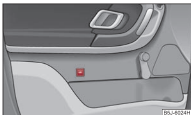
Fig. 31 Tasta instalației de supraveghere interioară
