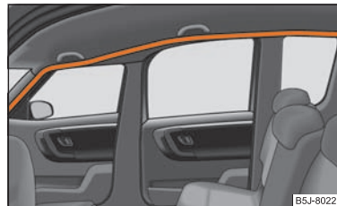
Fig. 115 Amplasarea airbagurilor cortină
