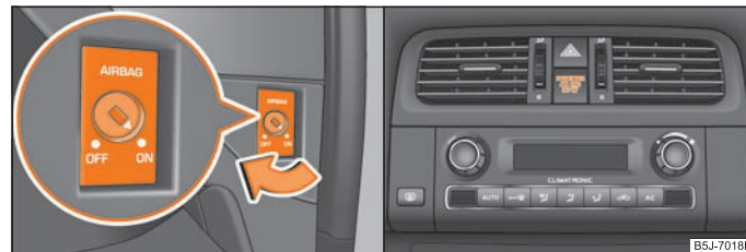
Fig. 117 Comutator pentru airbagul frontal al pasagerului din dreapta / Lampa de control pentru dezactivarea airbagului pasagerului din dreapta
