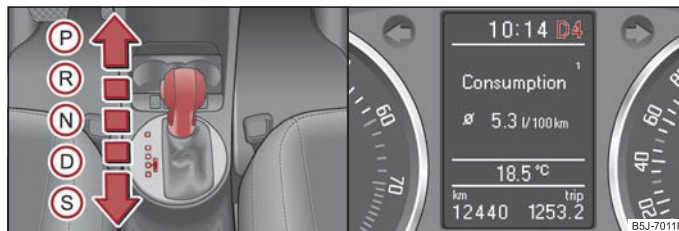
Fig. 97 Selectorul de viteze / Display-ul informativ: Pozițiile selectorului
