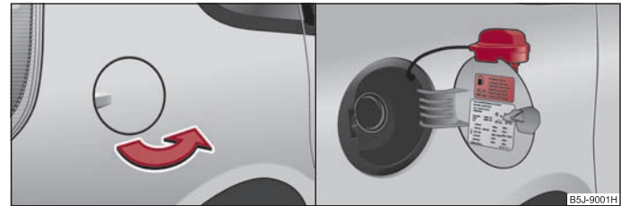
Fig. 11 Partea dreaptă spate a autovehiculului: Clapeta rezervorului / Clapeta rezervorului cu capacul deschis
