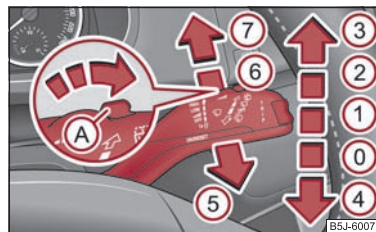
Fig. 9 Maneta de acționare a ștergătoarelor de parbriz
