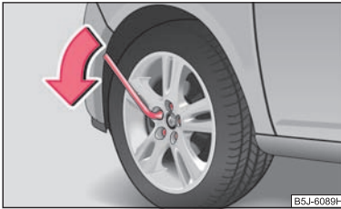
Fig. 150 : Slăbirea șuruburilor de roată
