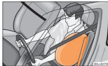
Fig. 114 Airbag lateral declanșat
