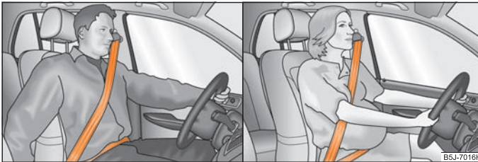
Fig. 107 Așezarea centurii diagonale și transversale / Așezarea centurii de siguranță la femeile însărcinate
