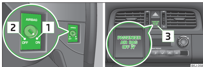
Fig. 120 Comutator cu cheie pentru airbagul frontal al pasagerului față / lampă de control pentru dezactivarea/activarea airbagului frontal al pasagerului față
