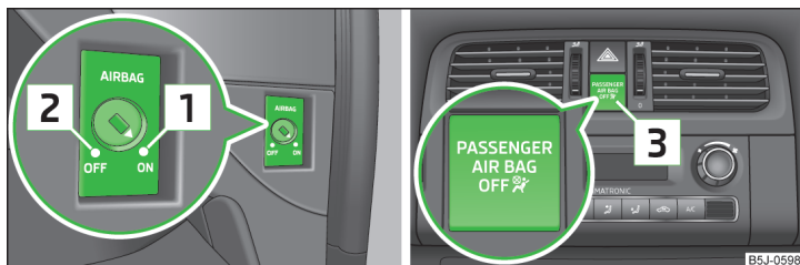
Fig. 12 Comutator cu cheie pentru airbagul frontal al pasagerului față / lampă de control pentru dezactivarea/activarea airbagului frontal al pasagerului față
