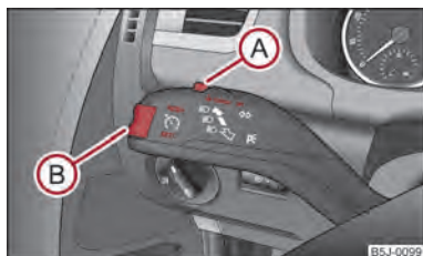
Fig. 82 Maneta: Tasta basculantă și comutatorul sistemului de control al vitezei de croazieră
