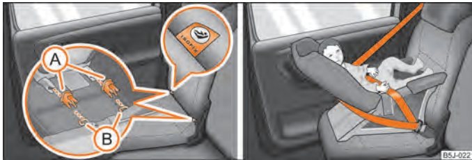
Fig. 111 Inelele de prindere (sistem ISOFIX) / scaunul pentru copii ISOFIX se montează în dispozitivele de prindere existente
