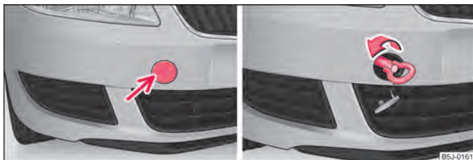
Fig. 144 Bara de protecție față: Capacul/montarea inelului de remorcare
