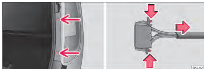
Fig. 160 Demontarea unității optice spate / Decuplarea contactului electric
