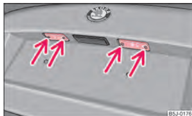
Fig. 159 Demontarea lămpii numărului de înmatriculare
