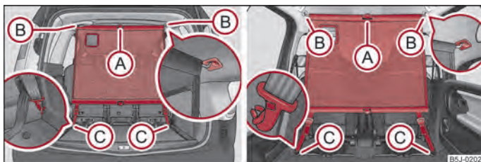
Fig. 48 Utilizarea plasei despărțitoare statice în spatele scaunelor din spate / în spatele scaunelor din față
