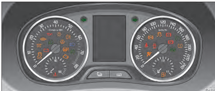
Fig. 8 Panou de bord cu lămpi de control
