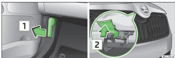
Fig. 113 Maneta de deblocare a capotei motorului / masca radiatorului: Maneta de deblocare
