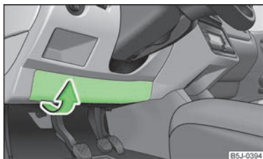
Fig. 139 Partea inferioară a planșei de bord: Capacul panoului de siguranțe
