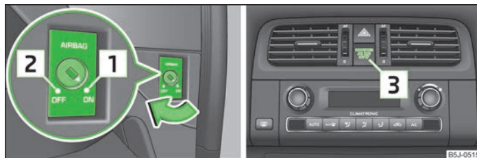
Fig. 103 Comutator cu cheie pentru airbagul frontal al pasagerului față / lampă de control pentru dezactivarea airbagului frontal al pasagerului față
