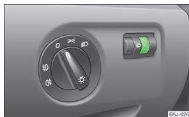
Fig. 23 Tabloul de bord: Reglarea fascicului farurilor (pe înălțime)
