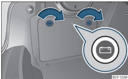
Fig. 207 Portbagajul: Bateria sub capac
