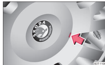
Fig. 218 Scoaterea ornamentului de roată la jantele din metal ușor
