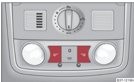
Fig. 65 Imagine din plafon: Lămpile pentru lectură din afață cu supraveghere interioară integrată
