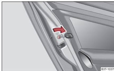
Fig. 39 Siguranța de la ușile din spate pentru copii
