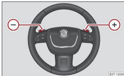
Fig. 150 Volanul multifuncțional: selectarea manuală a vitezelor
