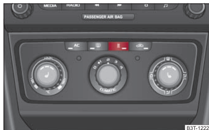
Fig. 129 Tasta pentru pornirea/oprirea directă a încălzirii suplimentare (încălzirea și ventilația în staționare) de la elementele de comandă Climatic
