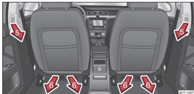
Fig. 126 Gurile de ventilație din spate
