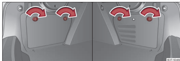
Fig. 116 Portbagajul: Compartimentul lateral - stânga / dreapta.
