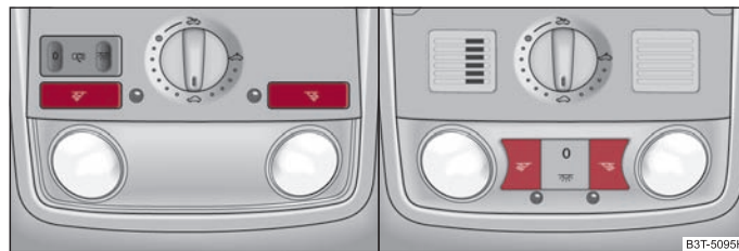
Fig. 54 Imagine din plafon: Lămpile de lectură din față/lămpile de lectură din față cu supraveghere interioară integrată
