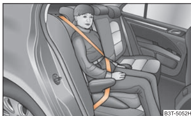
Fig. 167 Scaun pentru copii din grupa 3 montat pe scaunul din spate
