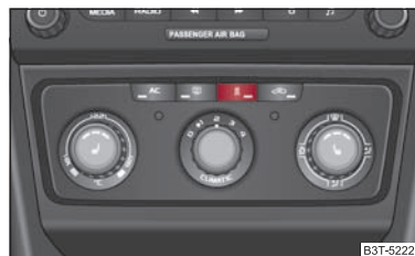
Fig. 123 Tasta pentru pornirea/oprirea directă a încălzirii suplimentare (încălzirea și ventilația în staționare) de la elementele de comandă Climatic
