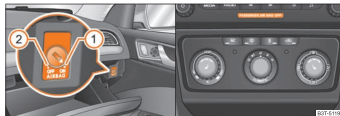
Fig. 161 Torpedoul: Comutator pentru airbagul frontal al pasagerului din dreapta / Lampa de control pentru dezactivarea airbagului pasagerului din dreapta
