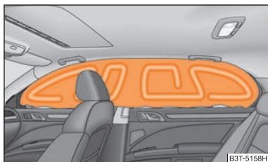
Fig. 160 Airbag cortină umplut cu gaz
