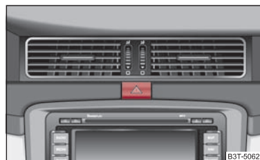
Fig. 51 Tabloul de bord: Înterupător pentru instalația de avertizare avarie
