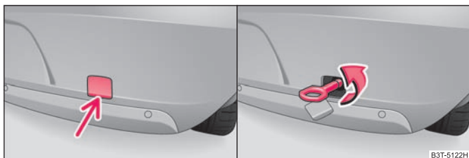
Fig. 204 Bara de protecție din spate: Demontarea capacului / Montarea inelului de tractare
