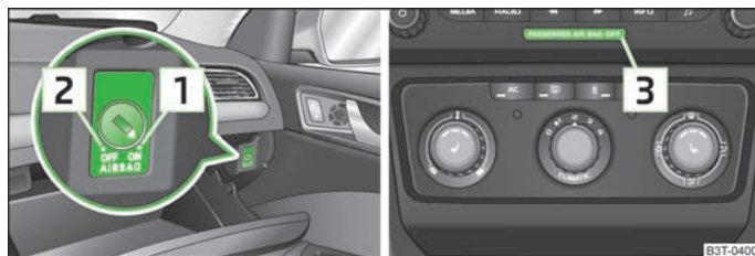
Fig. 149 Compartiment de depozitare: Comutator pentru airbagul frontal al pasagerului față / lampă de control pentru dezactivarea airbagului frontal al pasagerului față
