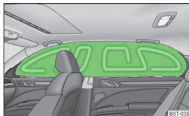
Fig. 148 Airbagul cortină umplut cu gaz
