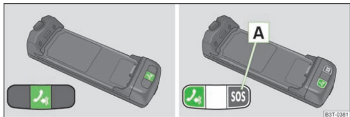
Fig. 131 Prezentarea de principiu: adaptorul cu o singură tastă / adaptorul cu două taste
