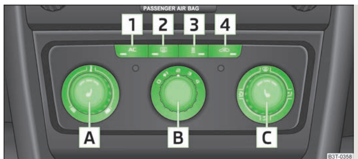
Fig. 108 Instalația de climatizare: elemente de comandă
