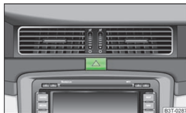
Fig. 37 Tabloul de bord: comutator pentru instalația de avertizare avarie
