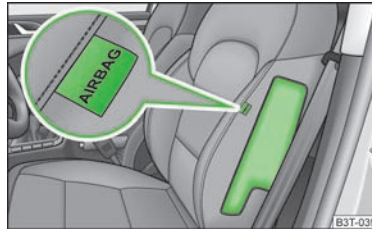
Fig. 145 Locul de amplasare al airbagului lateral în scaunul șoferului
