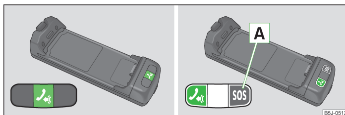
Fig. 115 Diagramă schematică: Adaptor cu o tastă / adaptor cu două taste
