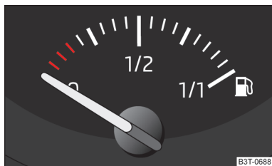
Fig. 5 Indicatorul de nivel combustibil
