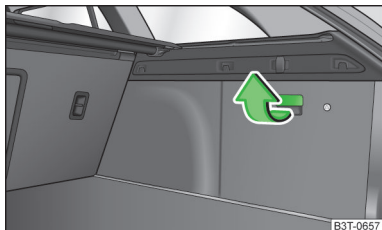
Fig. 106 Portbagajul Superb Combi: deschiderea compartimentului din dreapta
