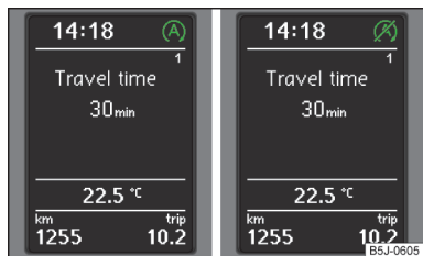
Fig. 151 Afișaj MAXI DOT: Motorul este oprit automat / oprirea automată a motorului nu este posibilă
