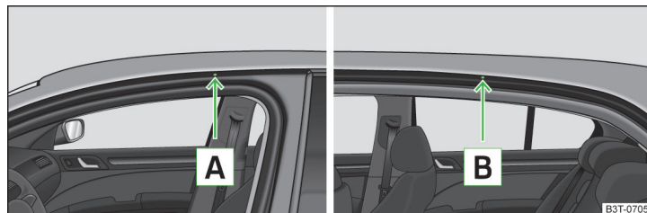
Fig. 121 Puncte de fixare ale suportului principal
