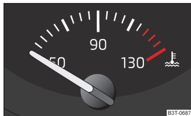
Fig. 21 Indicatorul temperaturii lichidului de răcire
