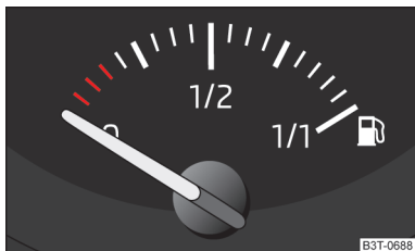
Fig. 23 Indicatorul de nivel combustibil
