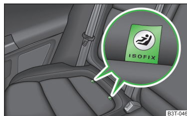
Fig. 17 Etichetele sistemului ISOFIX
