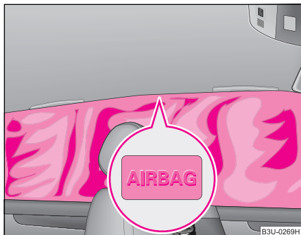
Fig. 137 Airbag-ul pentru cap deasupra ușii și inscripția Airbag pe capacul din stâlpul ușii
