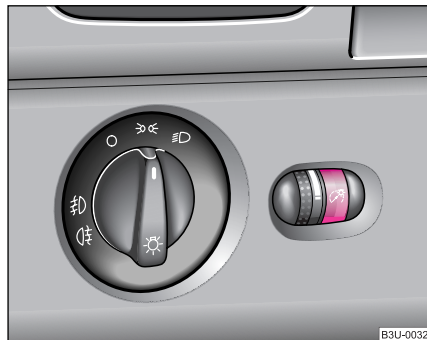
Fig. 35 Tabloul de bord: Iluminarea instrumentelor de bord
