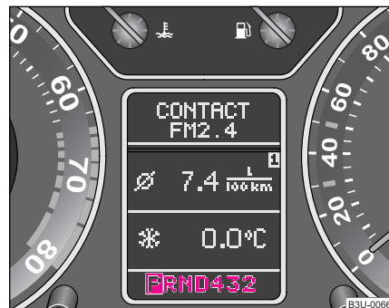
Fig. 114 Display-ul cu informații din tabloul de bord prin apariția simbolului corespunzător al treptei de viteză ♥ fig. 114.
