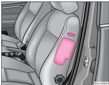
Fig. 135 Locul de amplasare al airbag-ului lateral în scaunul conducătorului
