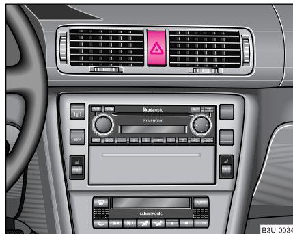
Fig. 37 Tabloul de bord: Înterupător pentru instalația de avertizare avarie
