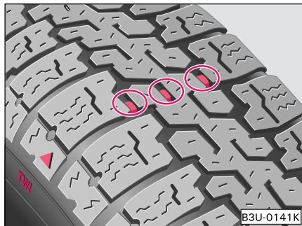
Fig. 166 Profilul anvelopei cu indicatorul de uzură
