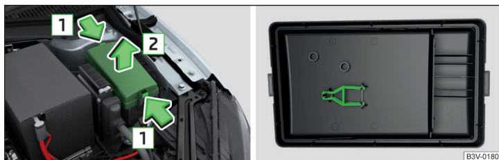
Fig. 268 Scoaterea capacului panoului de siguranțe/Clema din material plastic pentru siguranțe
