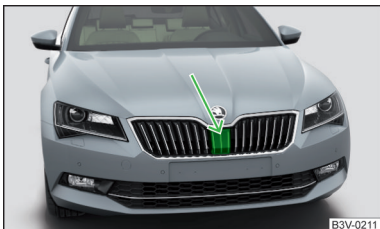
Fig. 205 Locul de amplasare al senzorului radar
