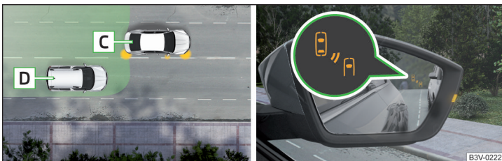
Fig. 215 Situație din trafic/Lampa de control din oglinda exterioră dreapta indică asupra situației din trafic
