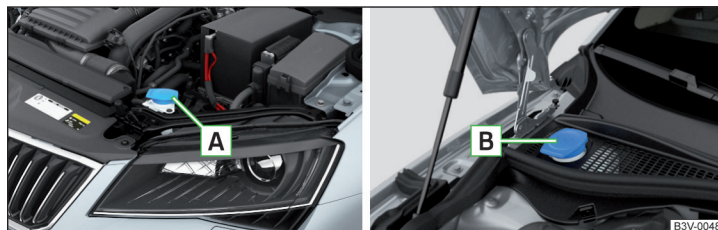
Fig. 228 Rezervorul lichidului de spălare
