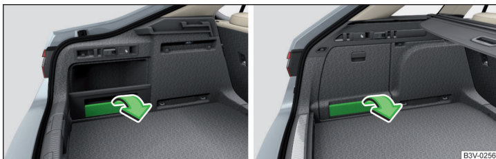
Fig. 137 Scoaterea elementelor Cargo: Varianta 1/ varianta 2
