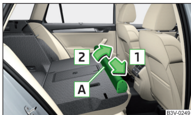
Fig. 149 Demontarea carcasei peretelui despărțitor din plasă
