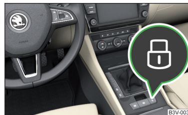
Fig. 38 Tasta de închidere centralizată
