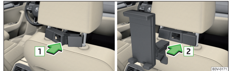
Fig. 122 Montarea adaptorului în tije de ghidare ale tetierei/Montarea suportului
