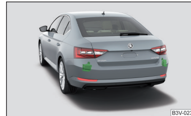
Fig. 213 Locul de amplasare al senzorilor radar
