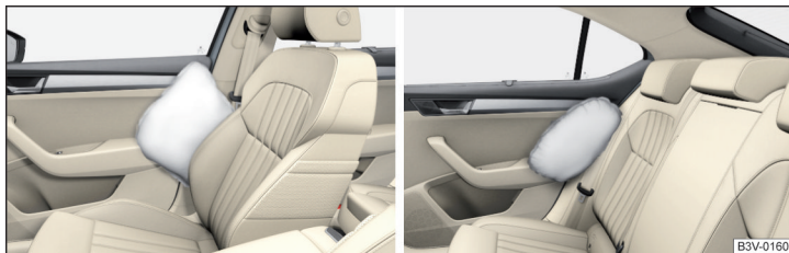
Fig. 11 Airbag umplut cu gaz
