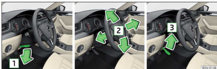
Fig. 2 Reglarea poziției volanului
