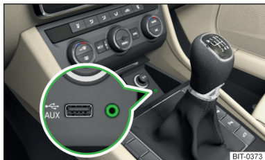
Fig. 109 Locul de amplasare al intrării AUX
