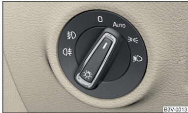
Fig. 54 Comutatorul de lumini: Poziția AUTO
