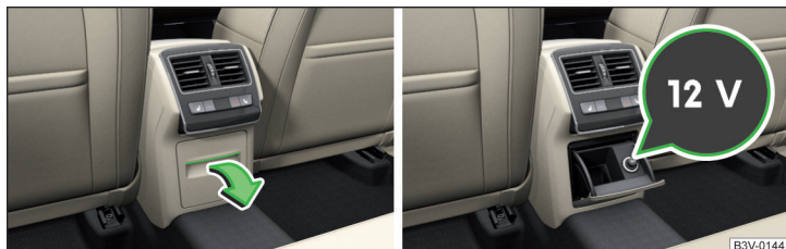
Fig. 112 Deschiderea compartimentului de depozitare/Capacul prizei 12 V
