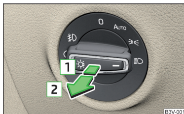
Fig. 55 Comutatorul de lumini: cuplarea farurilor de ceață și a lămpii de ceață spate
