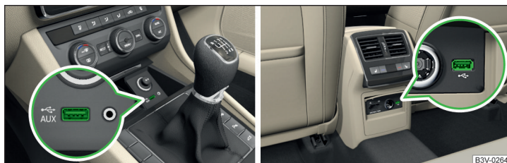
Fig. 108 Locurile de amplasare ale intrărilor USB în consola centrală față/spate
