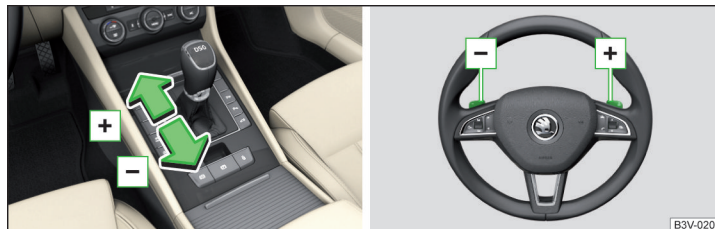
Fig. 169 Maneta selectorului de viteze/volanul multifuncțional
