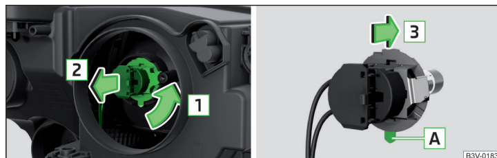
Fig. 271 Înlocuirea becului incandescent pentru faza scurtă și faza lungă
