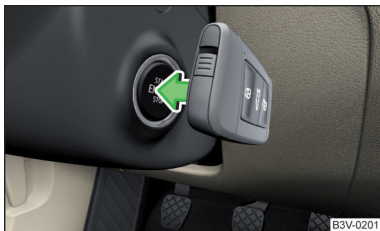
Fig. 161 Pornirea motorului - Mențineți cheia lângă buton
