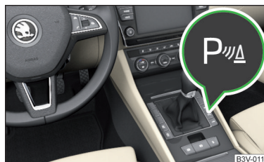
Fig. 182 Tasta pentru activare/dezactivare
