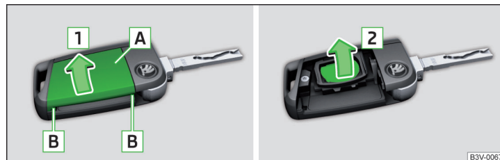
Fig. 253 Cheia cu telecomandă: Demontarea capacului/scoaterea bateriei
