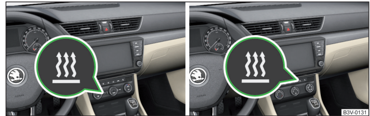
Fig. 157 Tasta pentru pornirea/oprirea directă a încălzirii suplimentare (încălzirea și ventilația în staționare) de la unitatea de comandă Climatronic/sistemul de aer condiționat manual
