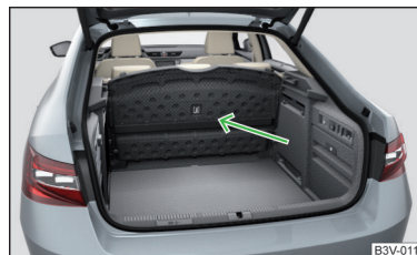
Fig. 131 Masca portbagajului depozitată în spatele scaunelor din spate
