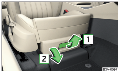
Fig. 100 Deschiderea compartimentului de depozitare
