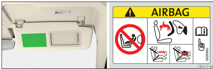
Fig. 15 Parasolarul pasagerului față/autocolant
