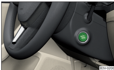
Fig. 160 Butonul de pornire (START ENGINE STOP)
