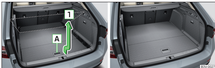
Fig. 143 Reglarea podelei variabile în poziția superioară/podea variabilă în poziție superioară
