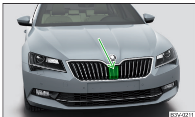
Fig. 199 Locul de amplasare al capacului senzorului radar
