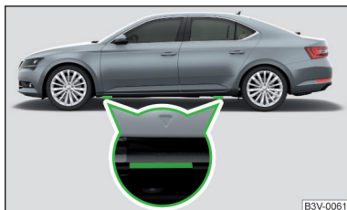
Fig. 245 Puncte pentru fixarea cricului
