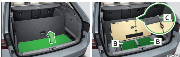
Fig. 140 Varianta 2: Ridicarea podelei portbagajului/Compartimentele de depozitare
