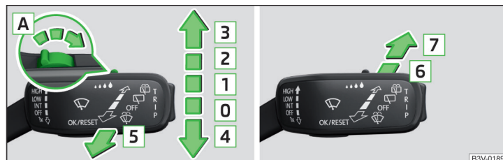
Fig. 67 Operarea ștergătoarelor de parbriz și instalației de spălare a parbrizului: față/spate
