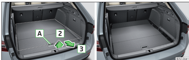
Fig. 144 Reglarea podelei variabile în poziția inferioară/podea variabilă în poziție inferioară
