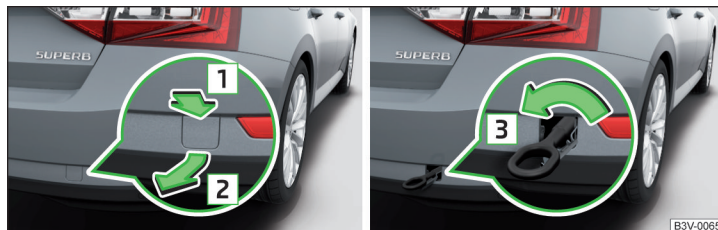
Fig. 252 Demontarea capacului/Montarea cârligului de tractare
