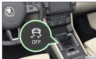
Fig. 172 Tasta sistemului ESC
