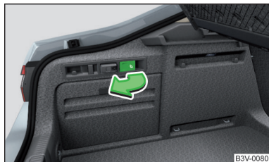
Fig. 77 Rabatarea spre înainte a spătarului scaunului din portbagaj
