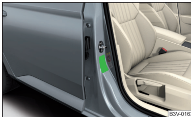
Fig. 14 Autocolant pe stâlpul B, pe partea pasagerului față
