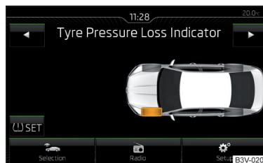
Fig. 218 Tasta pentru memorarea valorilor presiunii/exemplu de indicator de pe afișaj: sistemul atrage atenția asupra unei modificări a presiunii anvelopei din stânga față
