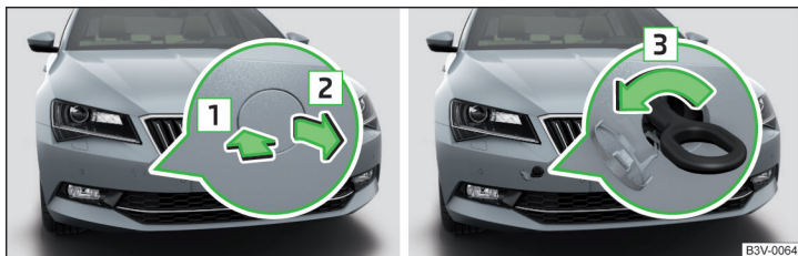
Fig. 251 Demontarea capacului/Montarea cârligului de tractare
