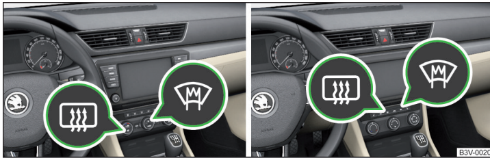
Fig. 63 Taste pentru încălzirea parbrizului și lunetei: Climatronic/Sistemul manual de aer condiționat
