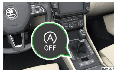
Fig. 163 Tasta pentru sistemul START-STOP
