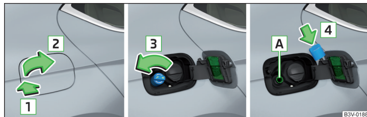
Fig. 225 Deschiderea clapetei rezervorului de combustibil/Deșurubarea bușonului rezervorului de combustibil/Introducerea bușonului rezervorului de combustibil în clapeta rezervorului de combustibil
