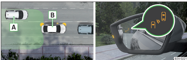
Fig. 214 Situație din trafic/Lampa de control din oglinda exterioră stânga indică asupra situației din trafic
