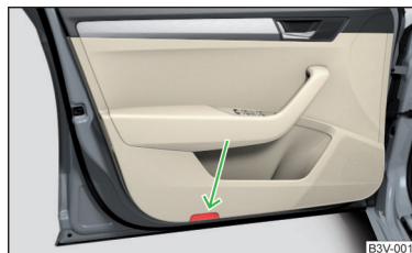
Fig. 62 Lampa de avertizare din portierele față
