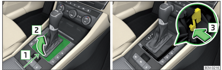
Fig. 262 Deblocarea de urgență a selectorului de viteze
