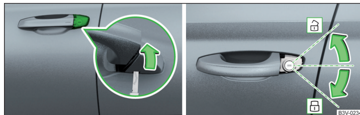
Fig. 258 Mânerul portierei șoferului: butucul încuietorii acoperit/rotirea cheii pentru descuiere și încuiere
