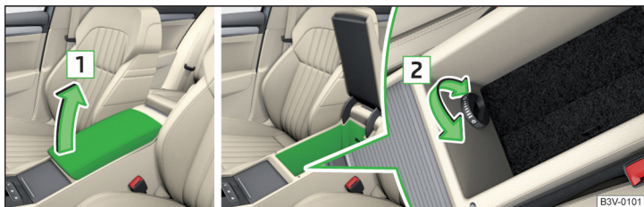
Fig. 96 Deschiderea compartimentului de depozitare/ operarea admisiei aerului
