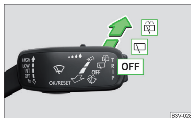
Fig. 60 Operarea instalației de ștergere și spălare a geamurilor
