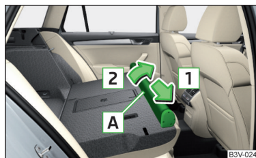
Fig. 141 Demontarea carcasei peretelui despărțitor din plasă
