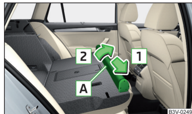
Fig. 164 Demontarea carcasei peretelui despărțitor din plasă
