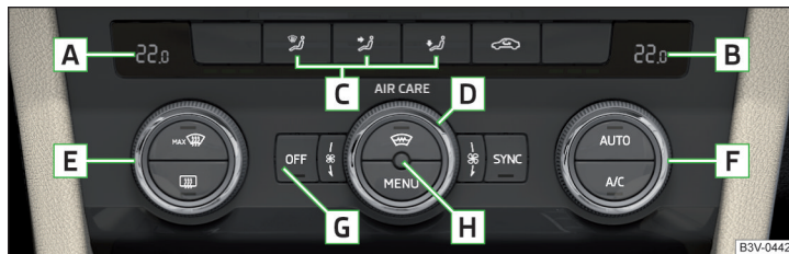
Fig. 167 Elementele de comandă față
