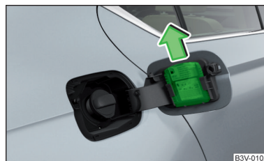
Fig. 317 Locul de montare al racletei, scoaterea racletei
