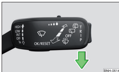
Fig. 357 Reglarea poziției de service a brațelor ștergătoarelor de parbriz
