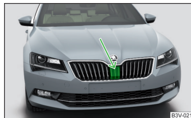
Fig. 268 Locul de montare al senzorului radar
