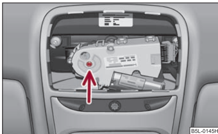
Fig. 53 Imagine din plafon: Acționarea în caz de urgență
