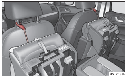
Fig. 86 Asigurarea scaunului lateral rabatat în față
