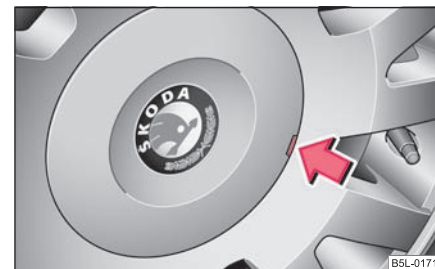
Fig. 223 Scoaterea ornamentului de roată la jantele din metal ușor
