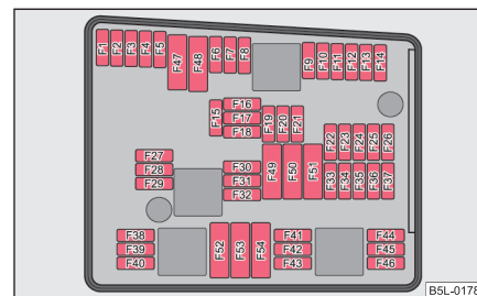
Fig. 234 Prezentare schematică a cutiei cu siguranțe din compartimentul motorului - Varianta 1
