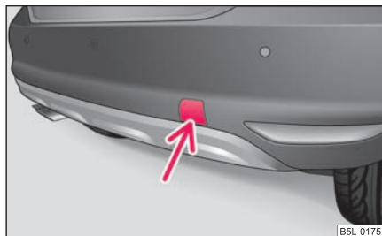
Fig. 230 Bara de protecție din spate: Demontarea capacului
