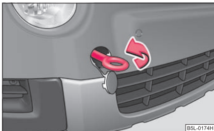
Fig. 229 Bara de protecție față: Montarea inelului de remorcare
