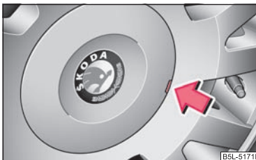
Fig. 177 Scoaterea ornamentului de roată la jantele din metal ușor
