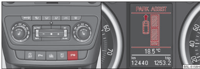
Fig. 111 Activarea asistenței la parcare /afișajul de informații: Găsirea unui spațiu de parcare adecvat
