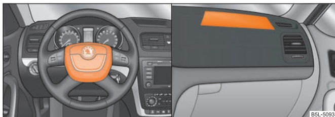
Fig. 129 airbagul șoferului în volan/ airbagul pasagerului din față în tabloul de bord
