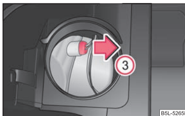
Fig. 190 Demontarea duliei luminii de poziție (far xenon)
