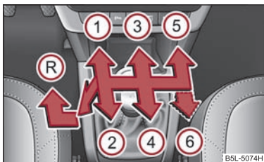
Fig. 107 Schemă de selectare: Cutie de viteze cu 5 trepte sau cu 6 trepte
