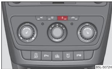
Fig. 104 Tasta pentru pornirea/oprirea directă a încălzirii suplimentare (încălzirea și ventilația în staționare) de la elementele de comandă Climatic
