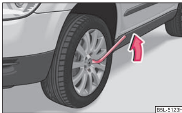
Fig. 178 Înlucuirea roții: Slăbirea șuruburilor de roată
