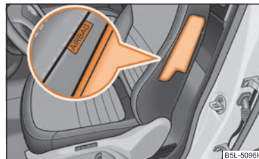
Fig. 133 Locul de amplasare al airbagului lateral în scaunul șoferului
