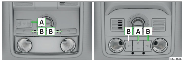
Fig. 51 Operarea lămpilor față: Varianta 1 / varianta 2
