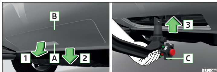
Fig. 147 Scoaterea clapetei de la bara de protecție din spate / introducerea tije cuplei
