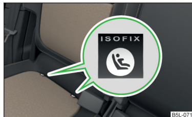
Fig. 18 Etichetele sistemului ISOFIX
