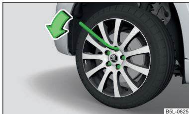
Fig. 174 Înlocuirea roții: Slăbirea șuruburilor de roată
