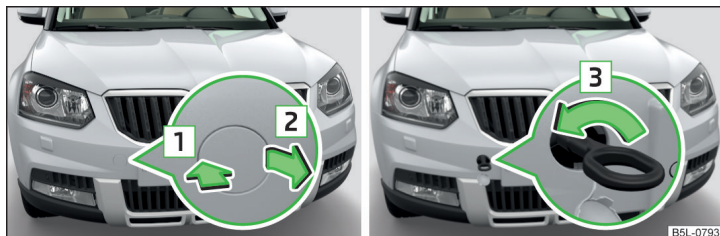
Fig. 181 Demontarea capacului / Montarea cârligului de tractare
