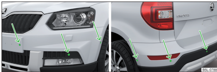
Fig. 134 Locul de amplasare al senzilor cu ultrasunete: față/spate
