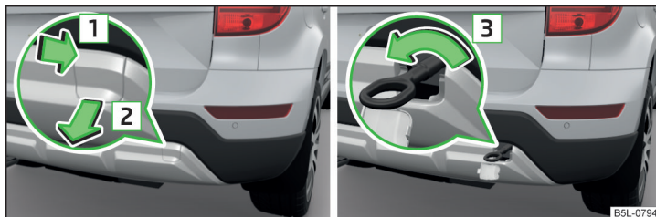
Fig. 182 Demontarea capacului / Montarea cârligului de tractare
