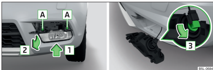
Fig. 201 Prezentarea în principiu: Demontarea farului de ceață / Înlocuirea becului
