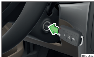
Fig. 122 Porniți motorul - apăsați butonul cu cheie.
