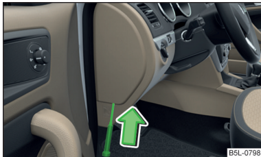
Fig. 192 Capacul panoului de siguranțe
