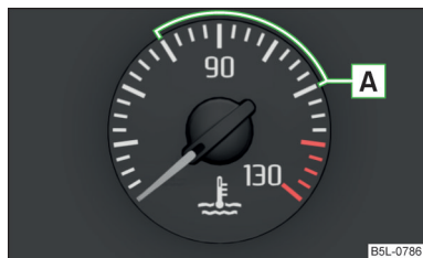
Fig. 22 Indicatorul temperaturii lichidului de răcire
