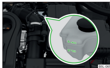
Fig. 162 Rezervorul de lichid de frână
