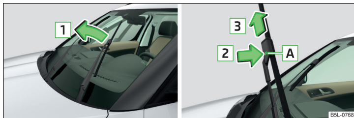
Fig. 190 Lamela ștergătorului de parbriz
