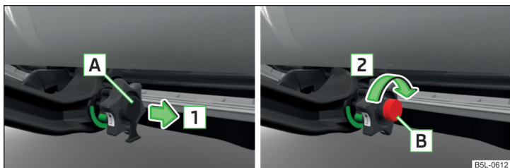
Fig. 149 Îndepărtarea capacului încuietorii / deblocarea încuietorii
