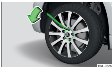
Fig. 174 Slăbirea șuruburilor de roată
