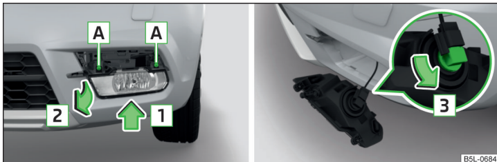
Fig. 202 Demontarea farului de ceață / înlocuirea becului
