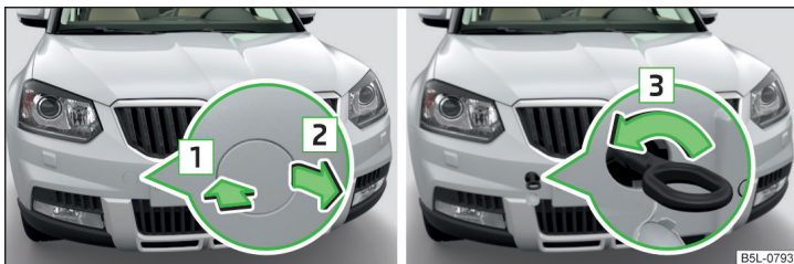
Fig. 180 Scoaterea capacului / montarea cârligului de tractare
