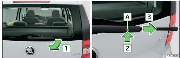
Fig. 191 Înlocuirea lamei ștergătorului de lunetă
