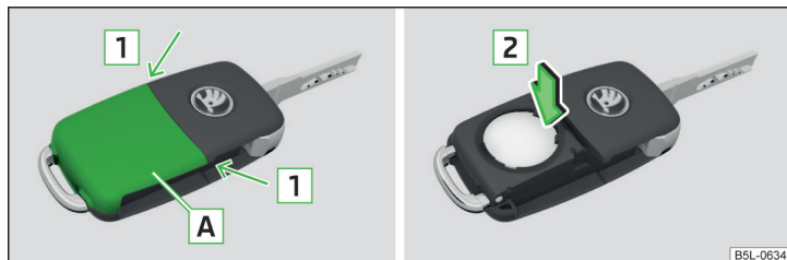
Fig. 182 Demontarea capacului / scoaterea bateriei
