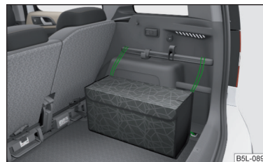
Fig. 102 Fixarea buzunarului multifuncțional
