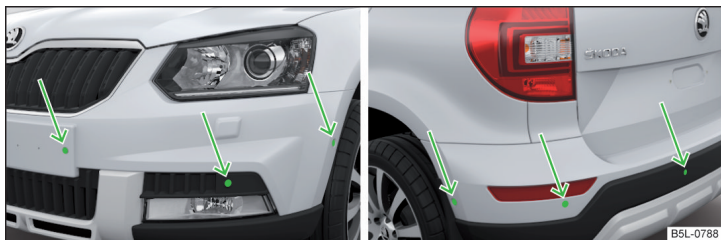
Fig. 133 Locul de amplasare al senzorilor de pe partea stângă a autovehiculului: față/spate
