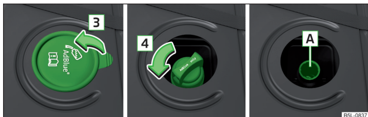
Fig. 157 Deschideți bușonul / Deșurubarea bușonului rezervorului de combustibil / Bușonul rezervorului de combustibil
