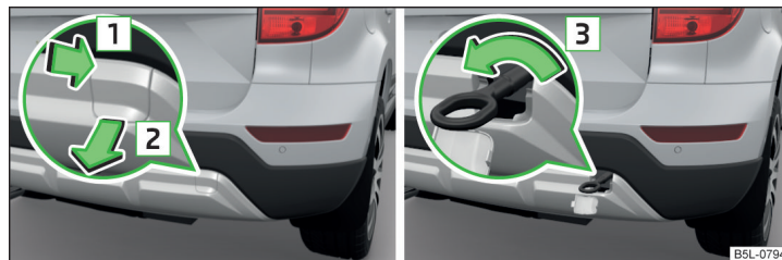
Fig. 181 Scoaterea capacului / montarea cârligului de tractare
