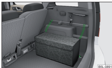
Fig. 102 Fixarea buzunarului multifuncțional
