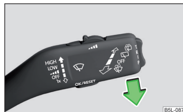
Fig. 189 Reglarea poziției de service a brațelor ștergătoarelor de parbriz
