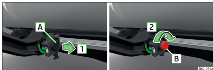
Fig. 149 Îndepărtarea capacului încuietorii / deblocarea încuietorii
