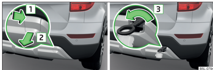
Fig. 181 Scoaterea capacului / montarea cârligului de tractare
