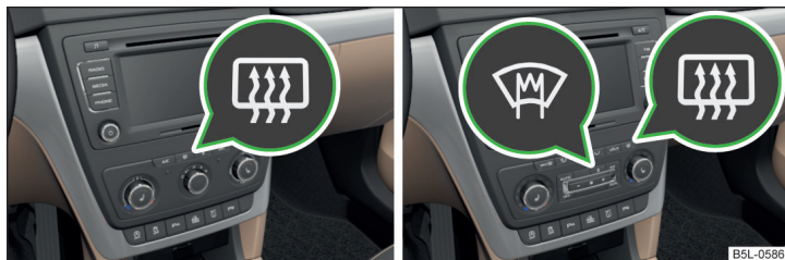
Fig. 49 Taste pentru încălzirea parbrizului și lunetei: instalație de climatizare manuală / Climatronic
