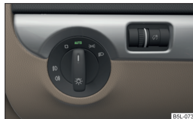
Fig. 44 Comutatorul de lumini: Poziția AUTO
