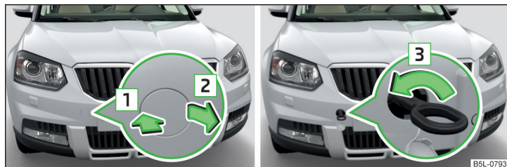
Fig. 180 Scoaterea capacului / montarea cârligului de tractare
