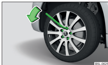
Fig. 174 Slăbirea șuruburilor de roată
