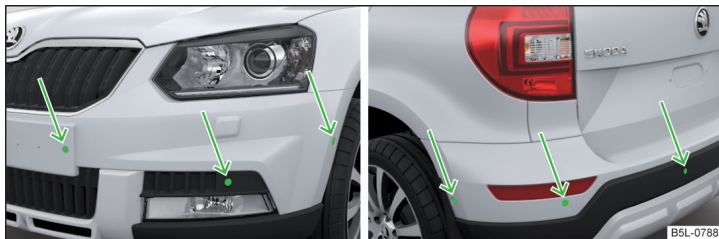
Fig. 133 Locul de amplasare al senzorial de pe partea stângă a autovehiculului: față/spate
