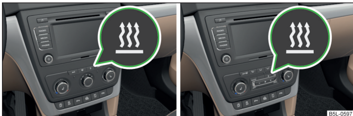
Fig. 119 Tasta pentru activarea/dezactivarea directă de pe elementul de comandă al sistemului manual de aer condiționat/Climatronic
