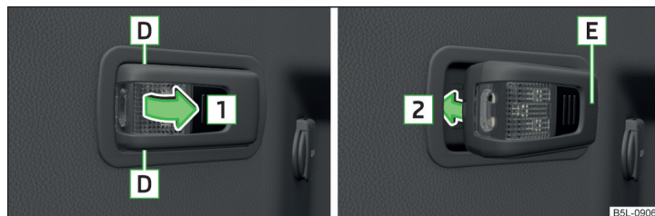
Fig. 110 Lampa cu posibilitate de demontare: scoaterea/introducerea
