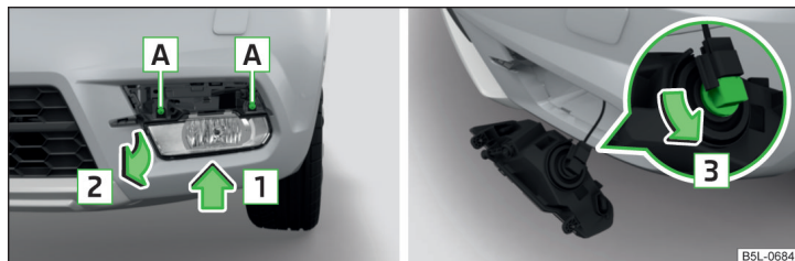
Fig. 202 Demontarea farului de ceață / înlocuirea becului
