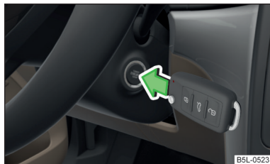
Fig. 122 Porniți motorul - apăsați butonul cu cheie.
