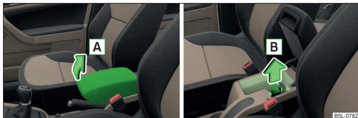
Fig. 85 Deschiderea compartimentului de depozitare/ deschiderea admisiei aerului
