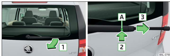
Fig. 191 Înlocuirea lamei ștergătorului de lunetă
