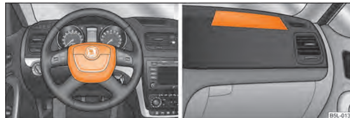
Fig. 121 airbagul șoferului în volan/airbagul pasagerului față în tabloul de bord
