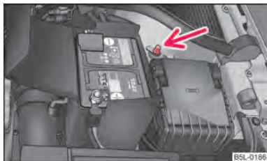
Fig. 174 Pornirea asistată la autovehiculele cu sistem START-STOPP
