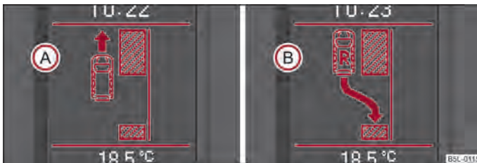
Fig. 102 Display-ul cu informații: spațiul de parcare găsit cu o indicație de a vă deplasa înainte (A) și de a selecta treapta de marșarier (B)
