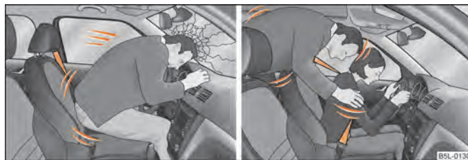
Fig. 117 Șoferul cu centura de siguranță nefixată este proiectat în față/pasagerul de pe locul din spate cu centura de siguranță nefixată este proiectat în față
