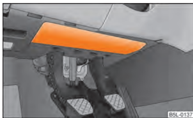
Fig. 124 Airbag pentru genunchi al șoferului, sub coloana volanului
