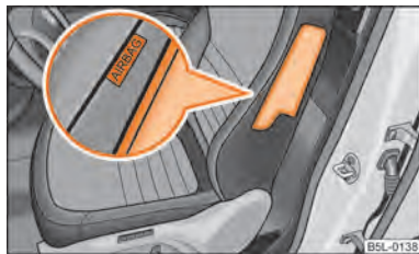
Fig. 125 Locul de amplasare al airbagului lateral în scaunul conducătorului
