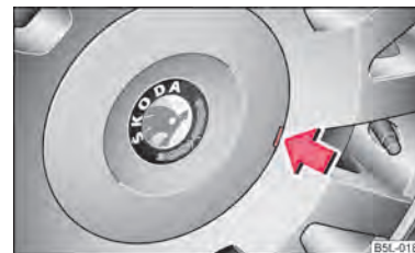
Fig. 167 Scoaterea ornamentului de roată la jantele din metal ușor
