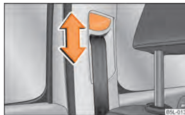
Fig. 119 Scaun față: Reglarea pe înălțime a centurii
