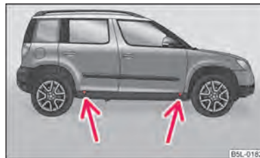
Fig. 169 Înlucirea roții: Puncte pentru fixarea cricului
