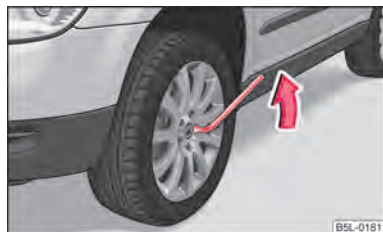
Fig. 168 Înlucirea roții: Slăbirea șuruburilor de roată
