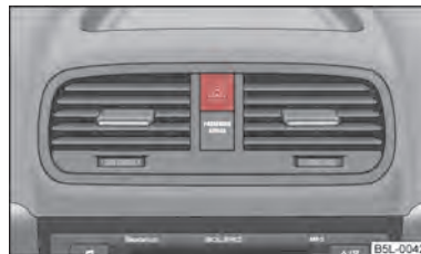
Fig. 29 Tabloul de bord: Înterupător pentru instalația de avertizare avarie
