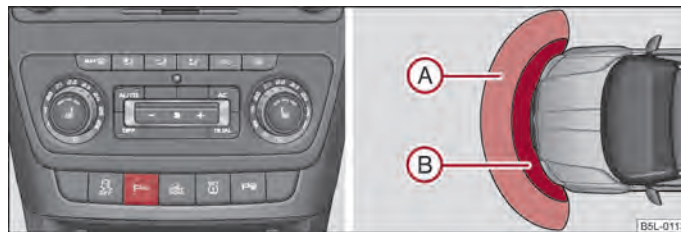
Fig. 100 Activarea sistemului de asistență la parcare/Domeniul de acțiune al senzorilor din față
