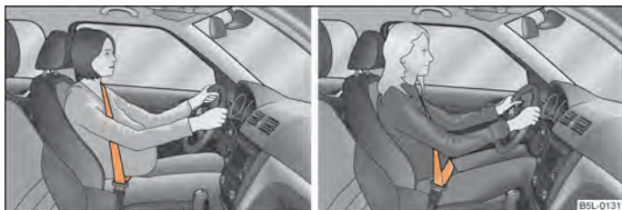
Fig. 118 Aranjarea centurii de siguranță la femeile însărcinate / Aranjarea centurii de umăr și de bazin
