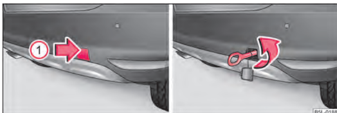
Fig. 176 Bara de protecție din spate: Demontarea capacului / Montarea cârligului de tractare
