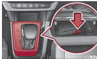
Fig. 108 Deblocarea de urgență a selectorului de viteze
