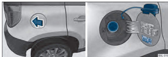
Fig. 150 Partea dreaptă spate a autovehiculului: Deschiderea clapetei rezervorului de combustibil /Clapeta rezervorului de combustibil cu capacul deschis
