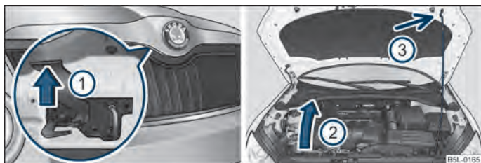
Fig. 152 Grilajul radiatorului: Maneta de siguranță/Asigurarea capotei motorului cu tija de susținere
