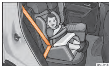
Fig. 132 Scaun cu măsura de siguranță din grupa 1 montat pe bancheta din spate, cu față la sensul de mers
