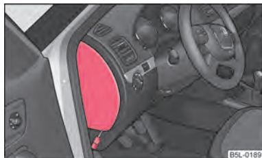
Fig. 177 Capacul suportului de siguranțe: Tabloul de bord, lateral
