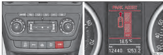
Fig. 101 Activarea sistemului de asistență direcție la parcare / afișajul informativ: Găsirea unui spațiu de parcare adecvat
