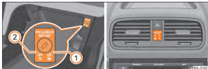
Fig. 129 Torpedoul: Comutator pentru airbagul frontal al pasagerului față/Lampa de control pentru dezactivarea airbagului pasagerului față
