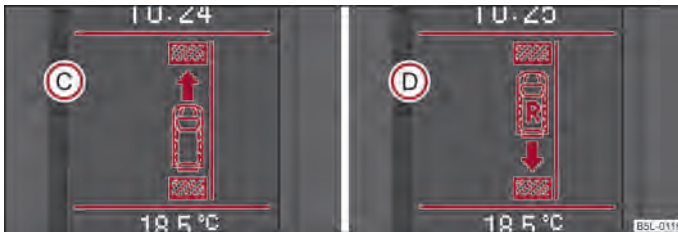
Fig. 103 Display-ul cu informații: indicație pentru selectarea unei trepte de viteză (C), respectiv a treptei de marșarier (D)
