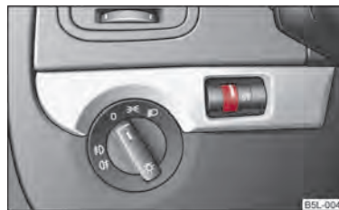
Fig. 27 Tabloul de bord: Iluminarea instrumentelor de bord
