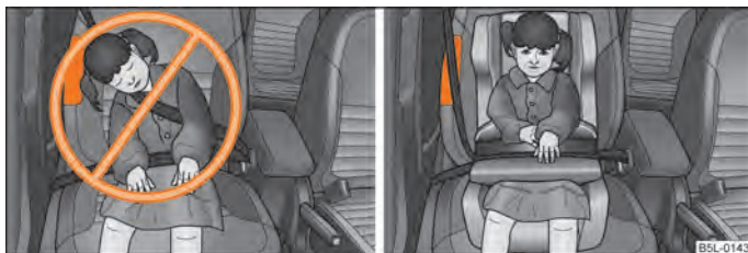
Fig. 130 Copil neasigurat corect într-o poziție incorectă - siguranța periclitată de airbagul lateral/copil asigurat corect într-un scaun pentru copii
