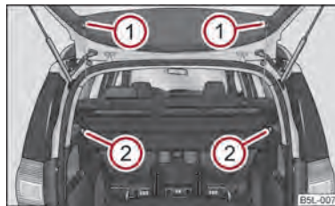
Fig. 61 Demontarea raftului din portbagaj
