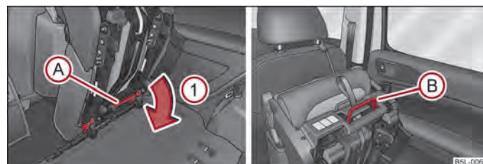
Fig. 52 Deblocarea scaunului rabatat în față / Mănerul de pe suprafața de șezut
