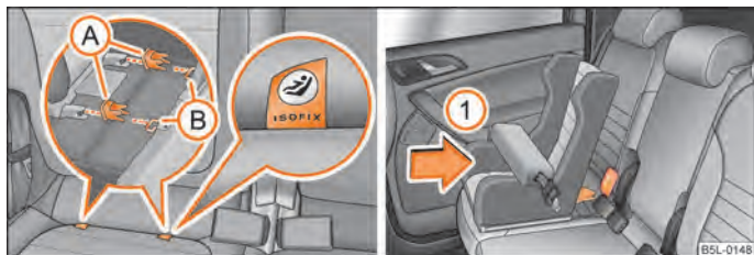
Fig. 135 Inelele de prindere (sistem ISOFIX) / scaunul pentru copii ISOFIX se montează în dispozitivele de prindere existente
