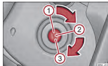
Fig. 96 Pozițiile cheii în contact
