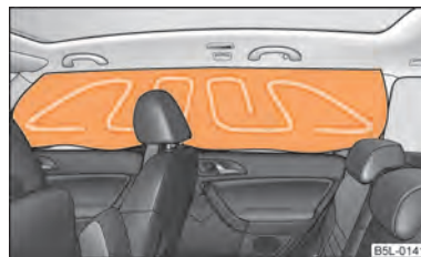
Fig. 128 Airbag cortină umplut cu gaz
