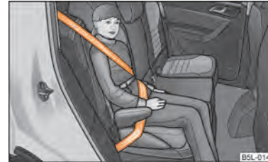
Fig. 134 Scaun pentru copii din grupa 3 montat pe scaunul din spate, cu fața la sensul de mers
