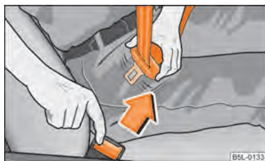
Fig. 120 Eliberarea elementului de prindere din dispozitiv
