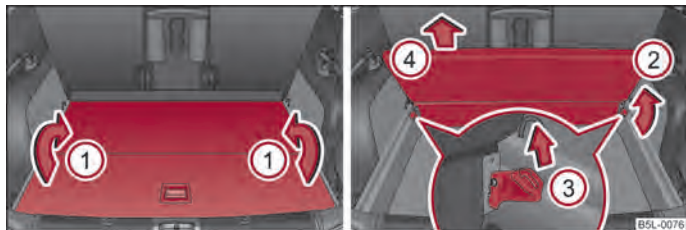
Fig. 63 Portbagajul: Plierea/Extragerea suprafeței de încărcare variabile
