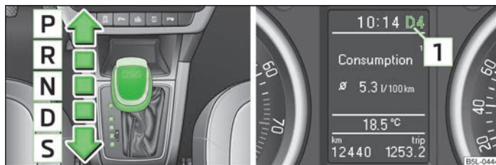
Fig. 107 Selectorul de viteze/Display-ul informativ: Pozițiile selectorului de viteze
