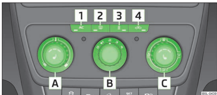
Fig. 90 Sistemul de aer condiționat: Elementele de comandă
