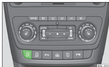
Fig. 106 Tasta pentru sistemul START-STOP
