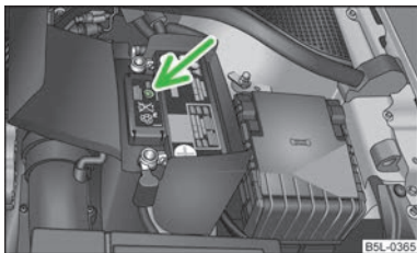
Fig. 147 Bateria autovehiculului: Indica- torul nivelului electrolitului
