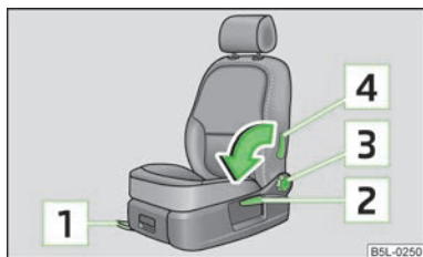
Fig. 42 Elemente de comandă pentru re- glarea manuală a scaunelor
