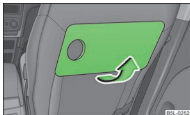
Fig. 80 Masa pliantă de la spătarul scaunelor din față
