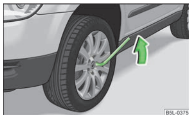
Fig. 156 Înlucuirea roții: Slăbirea șururilor de roată
