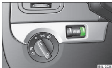
Fig. 27 Tabloul de bord: Reglarea fasciculului farurilor (pe înălțime)
