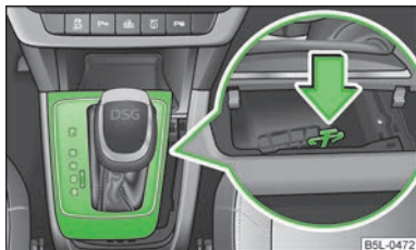
Fig. 109 Deblocarea de urgență a selectorului de viteze
