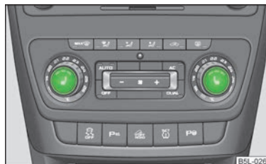
Fig. 46 Tabloul de bord: Regulator pentru încălzirea scaunelor din față
