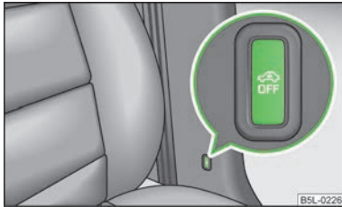
Fig. 14 Tastă pentru supravegherea interiorului și protecția la remorcare
