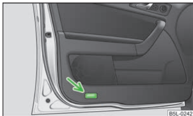
Fig. 33 Portieră față: lampă de avertizare
