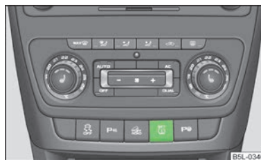
Fig. 153 Tastă pentru reglarea presiunii din anvelope
