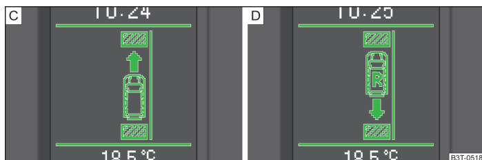
Fig. 104 Display-ul cu informații: Indicație pentru cuplarea treptei de mers înainte C , respectiv a treptei marșarier D
