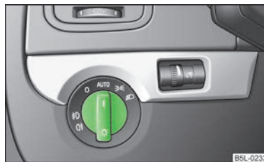
Fig. 24 Tabloul de bord: Comutatorul de lumini
