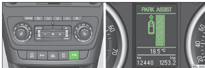
Fig. 102 Activarea afișajului sistemului de asistență direcție la parcare pe display-ul de informații/display-ul de informații: Căutarea unui spațiu de parcare adecvat
