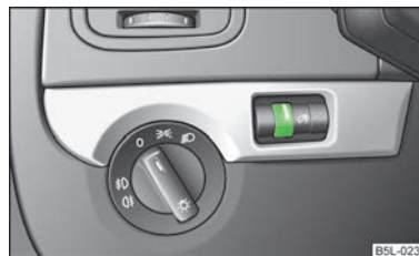
Fig. 26 Tabloul de bord: Iluminarea instrumentelor de bord
