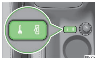
Fig. 12 Consola centrală: Tasta de închidere centralizată
