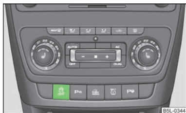
Fig. 97 Sistemul ESC: Tasta ASR
