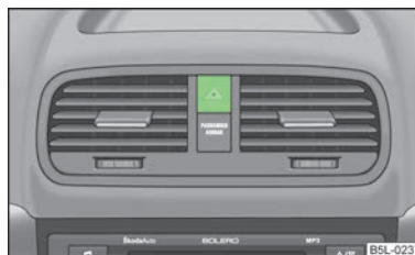
Fig. 28 Tabloul de bord: Comutator pentru luminile de avarie
