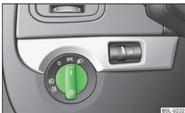
Fig. 23 Tabloul de bord: Comutatorul de lumini
