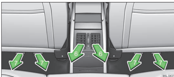
Fig. 88 Fantele de ventilație spate
