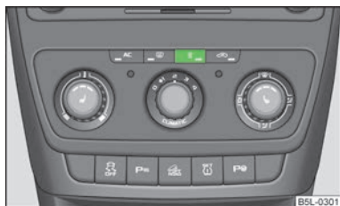
Fig. 92 Tasta pentru pornirea/oprirea directă a încălzirii suplimentare (încălzirea și ventilația în staționare) de la elementele de comandă ale instalației de climatizare
