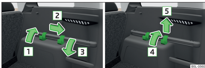
Fig. 80 Deplasarea cârligelor pe șipca de fixare / Demontarea cârligelor
