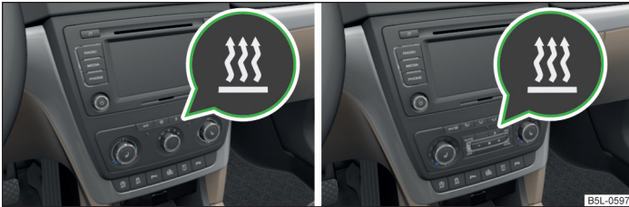
Fig. 96 Tasta pentru activarea/dezactivarea directă de pe elementul de comandă al sistemului de aer condiționat / Climatronic
