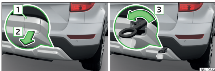
Fig. 182 Demontarea capacului / Montarea cârligului de tractare
