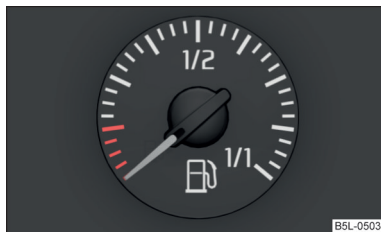
Fig. 5 Indicatorul de nivel combustibil
