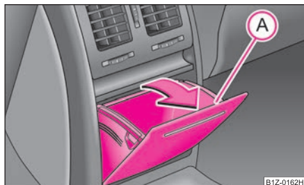
Изобр. 109 задний участок выступающей части пола между сиденьями: вещевой ящик
