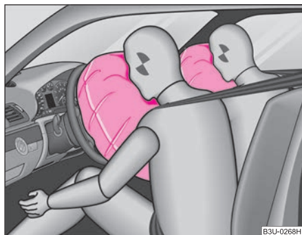
Изобр. 166 Раздутые подушки безопасности, заполненные газом
