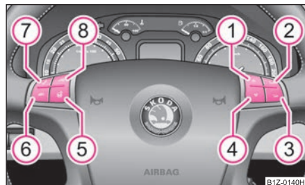
Изобр. 150 Многофункциональное рулевое колесо: кнопки управления автомобильным радиоприемником и телефоном
