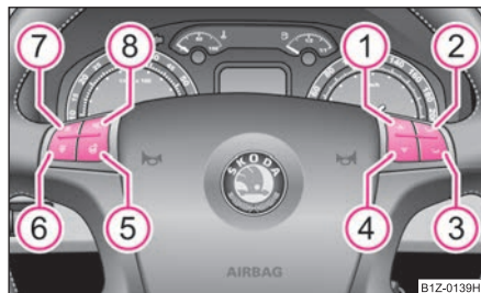
Изобр. 149 Многофункциональное рулевое колесо: кнопки управления автомобильным радиоприемником
