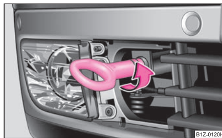
Изобр. 219 Передний бампер: установка буксирной петли
