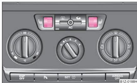
Изобр. 70 Панель приборов: поворотный регулятор обогрева передних сидений
