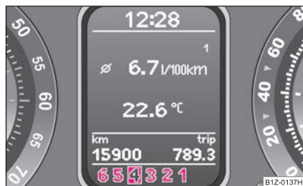
Изобр. 142 Большой информационный дисплей: переключение передач вручную
