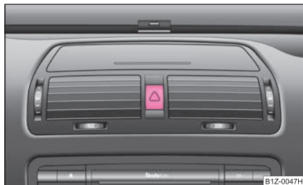
Изобр. 44 Панель приборов: выключатель для системы аварийной световой сигнализации
