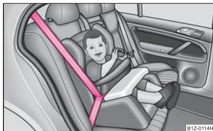
Изобр. 178 Специальное сиденье для ребенка категории 1 с предохранительным столиком на заднем сиденье по направлению движения автомобиля
