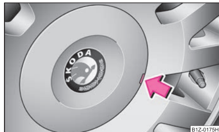
Изобр. 213 Снятие декоративного колпака колес из легкого сплава
