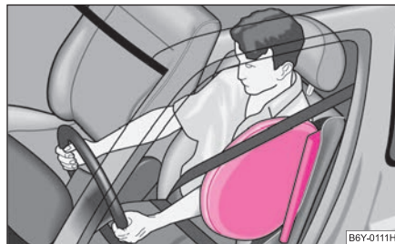
Изобр. 169 Раздутые боковые подушки безопасности, заполненные газом
