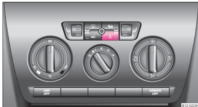
Изобр. 129 Кнопка для непосредственного включения (выключения) независимого дополнительного отопителя и вентиляции на панели управления устройством Climatic
