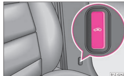
Изобр. 33 Кнопка устройства для наблюдения за внутренним пространством автомобиля
