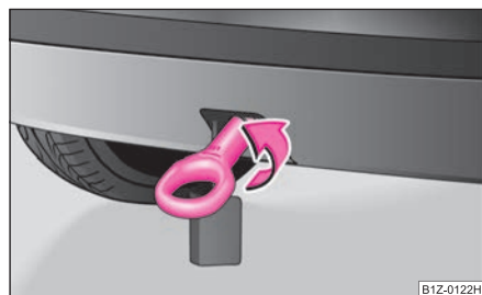
Изобр. 221 Задний бампер: установка буксирной петли
