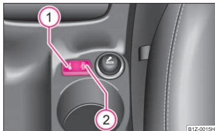
Изобр. 27 Выступающая часть пола между передними сиденьями: выключатель системы замков с центральным управлением
