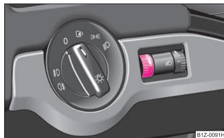
Изобр. 42 Панель приборов: освещение приборов
