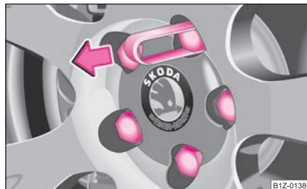
Изобр. 212 Снятие колпака болта крепления колеса
