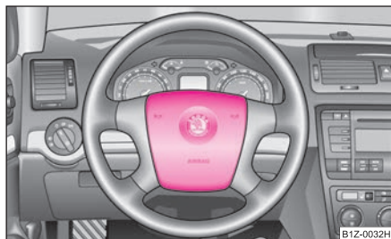
Изобр. 164 Надувная подушка безопасности для водителя в рулевом колесе
