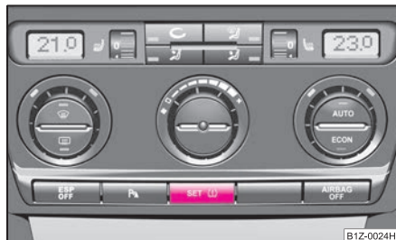
Изобр. 186 Выключатель для настройки опорного значения для контроля давления воздуха в шинах
