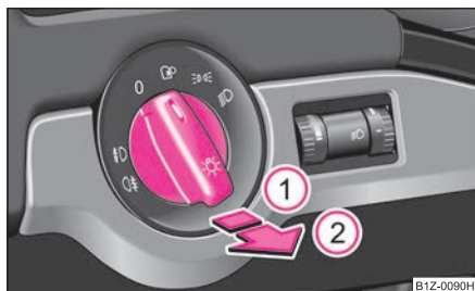
Изобр. 39 Панель приборов: переключатель света
