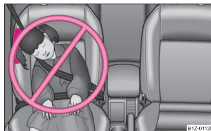
Изобр. 175 Неправильно пристегнутый ребенок, находящийся на сиденье в положении, в котором он подвергается опасности со стороны боковой надувной подушки безопасности
