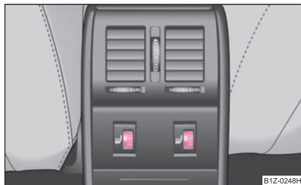
Изобр. 71 Средняя панель на заднем сиденье: поворотный регулятор обогрева задних сидений
