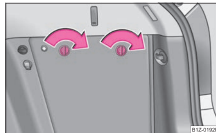
Изобр. 208 Расположение знака аварийной остановки (Combi)
