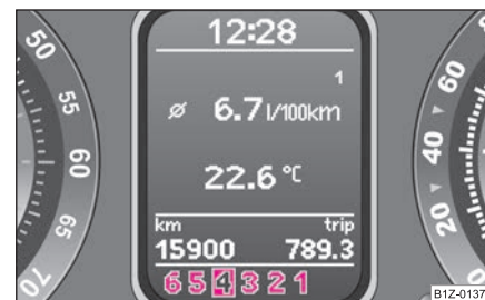
Изобр. 147 Большой информационный дисплей: переключение передач вручную
