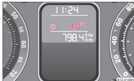
Изобр. 7 Многофункциональный указатель: температура наружного воздуха
