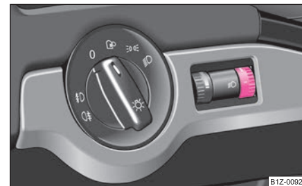
Изобр. 43 Панель приборов: регулирование угла наклона фар
