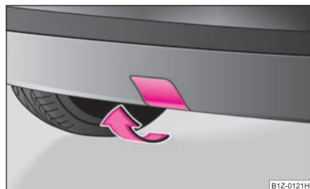
Изобр. 220 Задний бампер: удаление крышки
