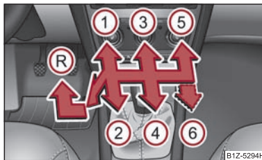
Изобр. 112 Схема переключения передач: пяти- или же шестиступенчатой коробки передач
