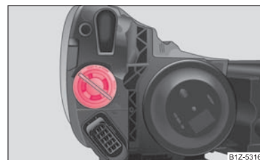
Изобр. 191 Извлечение лампы накаливания переднего фонаря указателя поворота
