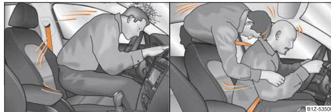
Изобр. 129 Непристегнутого водителя выбрасывает вперед / непристегнутого пассажира заднего сиденья выбрасывает вперед
