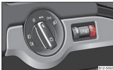
Изобр. 41 Панель приборов: регулирование угла наклона фар
