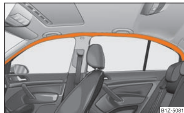
Изобр. 138 Место сборки надувной подушки безопасности Airbag для защиты головы
