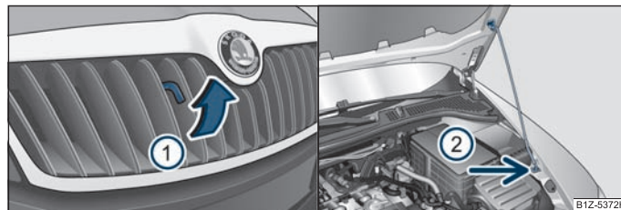
Изобр. 161 Решетка радиатора: Рукоятка фиксатора / фиксация капота двигателя опорой
