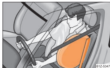
Изобр. 137 Раздутая боковая подушка безопасности, заполненная газом
