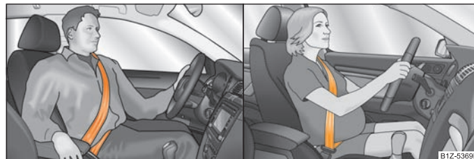
Изобр. 130 Прохождение плечевого и поясного ремней безопасности по телу
