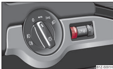
Изобр. 40 Панель приборов: Освещение приборов
