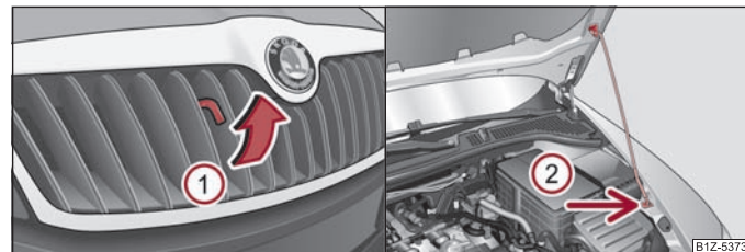
Изобр. 13 Решетка радиатора: Рукоятка фиксатора / фиксация капота двигателя опорой
