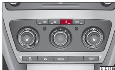
Изобр. 109 Кнопка для непосредственного включения (выключения) независимого дополнительного отопителя и вентиляции на панели управления устройством Climatic
