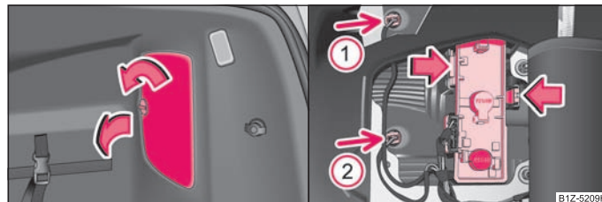
Изобр. 197 Багажник: крышка держателя лампы / снятие держателя лампы
