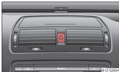
Изобр. 42 Панель приборов: Выключатель для системы аварийной световой сигнализации
