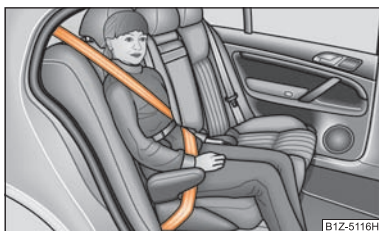
Изобр. 146 Сиденье для ребенка категории 3, устанавливаемое на заднем сиденье по направлению движения автомобиля
