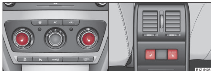
Изобр. 64 Панель приборов: регулятор обогрева передних / задних сидений
