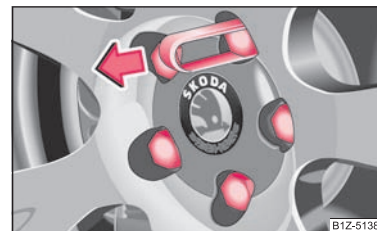
Изобр. 176 Снятие колпака болта крепления колеса
