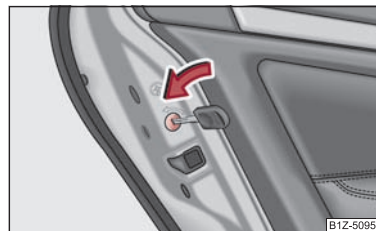
Изобр. 24 Приспособление защиты дверей от открытия детьми, установленное на задней боковой двери
