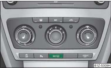
Изобр. 151 Выключатель для настройки опорного значения для контроля давления воздуха в шинах
