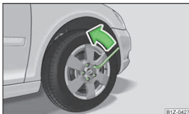
Илл. 148 Замена колеса: откручивание колёсных болтов
