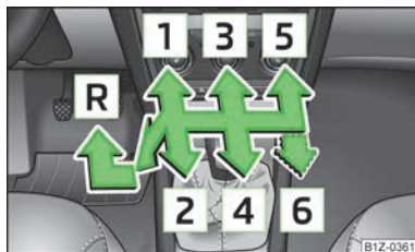
Илл. 98 Схема переключения: 5-ступенчатая или 6-ступенчатая коробка передач
