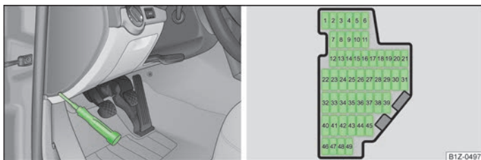
Илл. 158 Крышка блока предохранителей в передней панели / схематичное представление блока предохранителей
