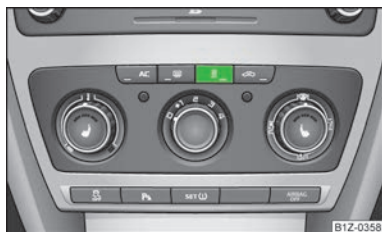
Илл. 91 Кнопка для прямого включения/выключения дополнительного отопителя (автономного отопления и вентиляции) на панели управления климатической установкой
