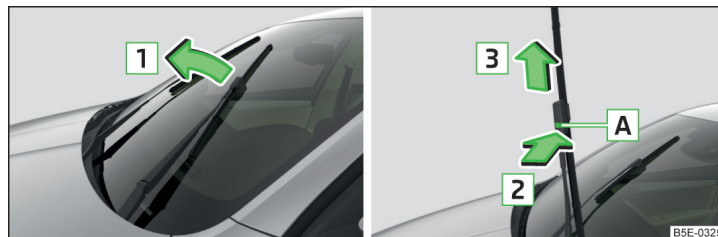
Илл. 340 Замена щётки стеклоочистителя ветрового стекла
