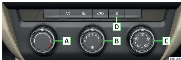
Илл. 126 Органы управления системой отопления, вентиляции и климатической установкой
