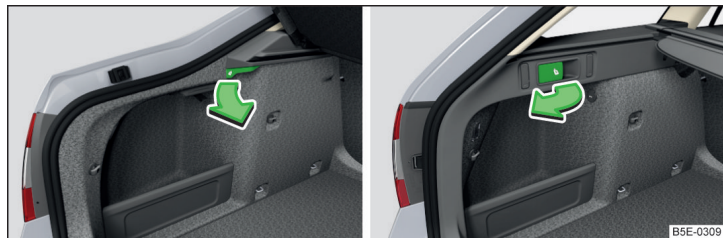
Илл. 67 Складывание спинки сиденья со стороны багажного отсека: вариант 1 / вариант 2
