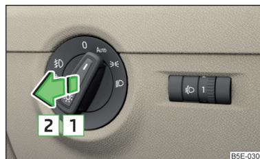
Илл. 48 Переключатель освещения: включение противотуманных фар / заднего противотуманного фонаря
