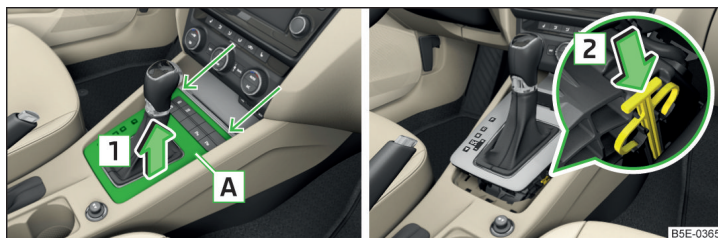
Илл. 224 Снятие крышки / разблокировка рычага селектора
