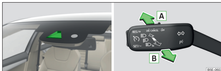
Илл. 47 Смотровое окошко датчика ассистента управления дальним светом / включение и выключение системы
