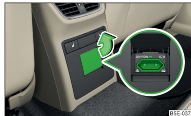
Илл. 93 Открытие крышки розетки на 230 В
