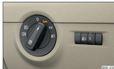
Илл. 46 Переключатель освещения: положение AUTO
