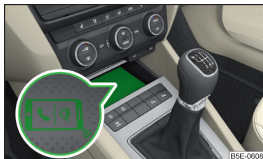
Илл. 77 Отсек для мобильного телефона (Phonebox)
