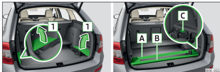
Илл. 125 Снятие боковых накладок багажного отсека / хранение снятого с крыши багажника
