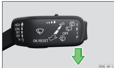
Илл. 225 Установка поводков стеклоочистителя в сервисное положение
