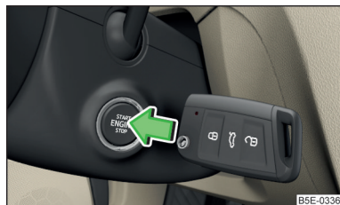
Илл. 133 Запуск двигателя: нажмите кнопку пуска непосредственно ключом
