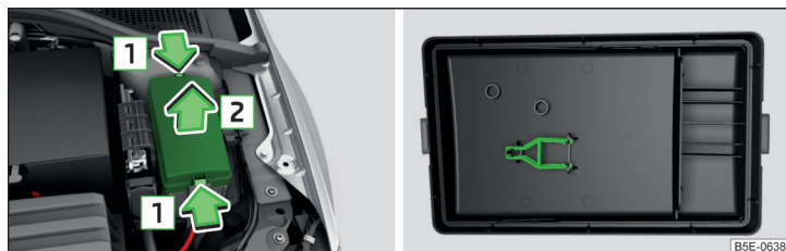
Илл. 232 Крышка блока предохранителей: снятие крышки / пластмассовый пинцет для предохранителей
