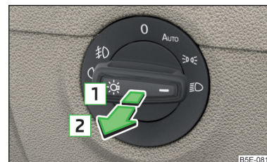
Илл. 61 Переключатель освещения: включение противотуманных фар/заднего противотуманного фонаря
