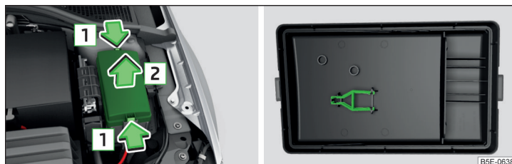
Илл. 338 Крышка блока предохранителей: снятие крышки/пластмассовый пинцет для предохранителей
