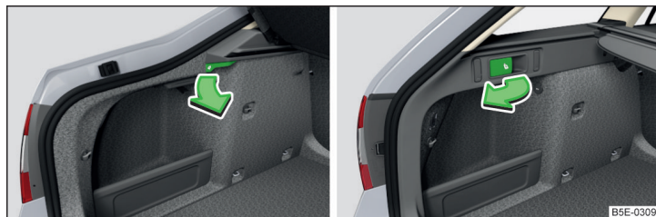
Илл. 80 Складывание спинки сиденья со стороны багажного отсека: вариант 1/вариант 2
