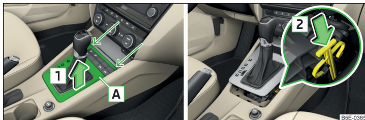
Илл. 330 Снятие накладки/разблокировка селектора
