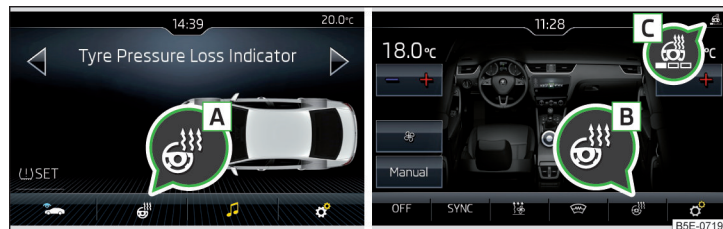
Илл. 86 Подогрев рулевого колеса: климатическая установка с ручным управлением/Climatronic
