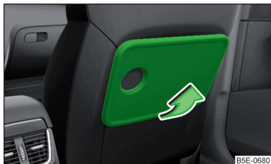
Илл. 103 Раскладывание откидного столика
