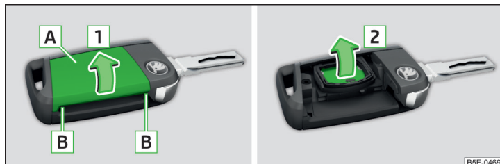
Илл. 325 Открытие крышки/извлечение элемента питания
