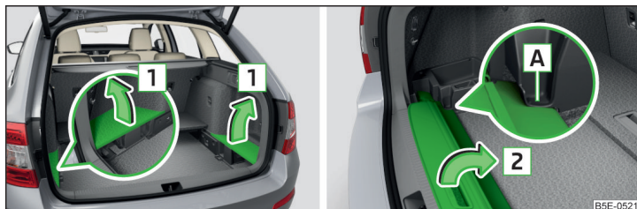
Илл. 128 Извлечение боковых накладок/хранение сматывающейся шторки
