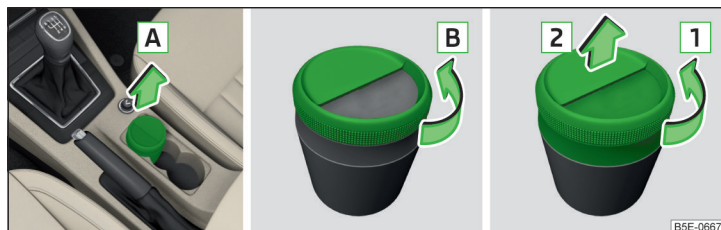
Илл. 109 Извлечение/открытие/разборка пепельницы
