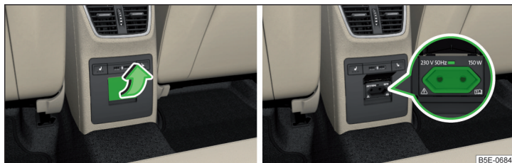
Илл. 108 Открытие крышки розетки 230 В/розетка 230 В
