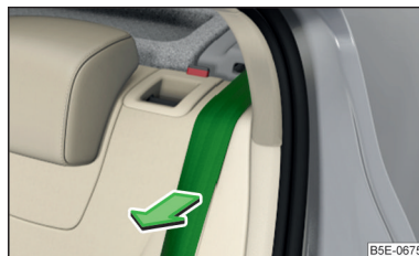
Илл. 10 Разблокировка инерционной катушки ремня безопасности
