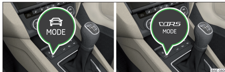
Илл. 273 Клавиша выбора режима движения: вариант 1/вариант 2
