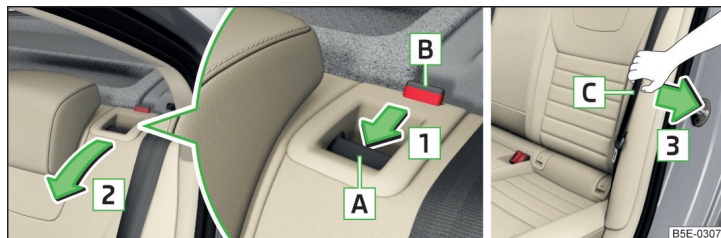
Илл. 79 Складывание спинки сиденья вперёд изнутри салона/отведение ремня к боковой облицовке
