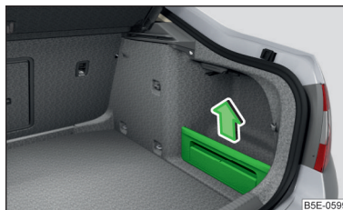
Илл. 129 Извлечение вещевого отсека
