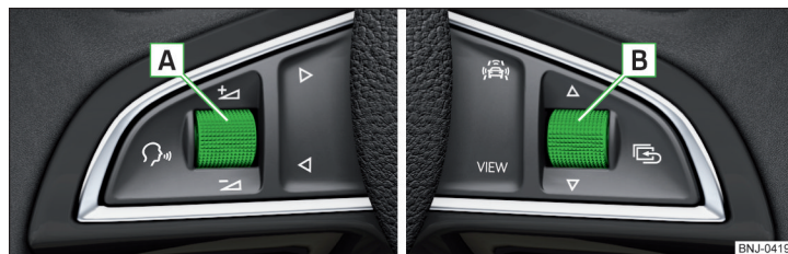
Илл. 37 Кнопки/регуляторы на многофункциональном рулевом колесе
