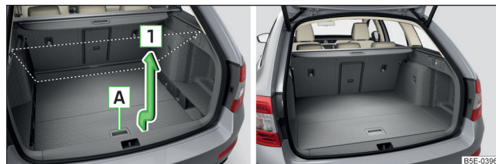
Илл. 133 Перевод трансформируемого пола в верхнее положение/трансформируемый пол в верхнем положении
