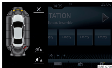
Илл. 242 Дисплей системы Infotainment: индикация при автоматическом включении
