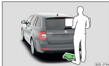
Илл. 50 Открывание крышки багажного отсека
