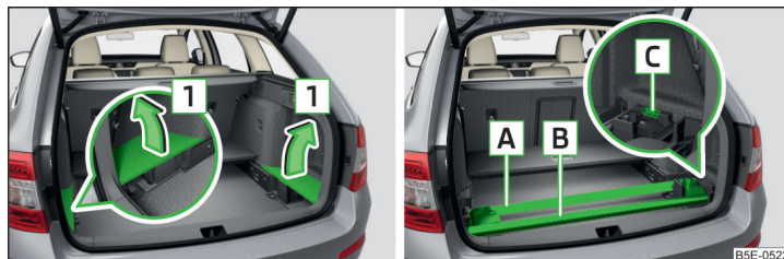
Илл. 141 Снятие боковых накладок багажного отсека/хранение снятого с крыши багажника
