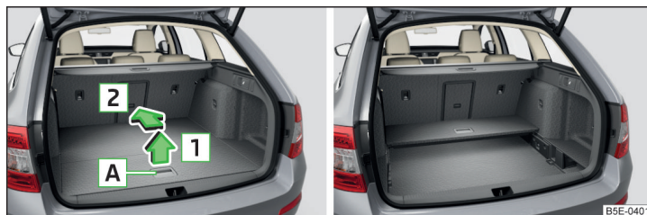
Илл. 135 Складывание трансформируемого пола/сложенный трансформируемый пол в верхнем положении
