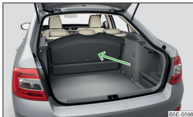
Илл. 126 Укладка полки багажного отсека за спинкой заднего сиденья
