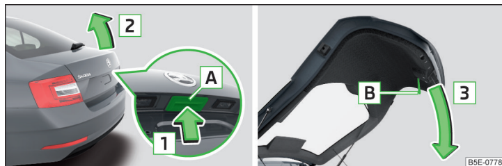
Илл. 48 Открытие и закрытие крышки багажного отсека
