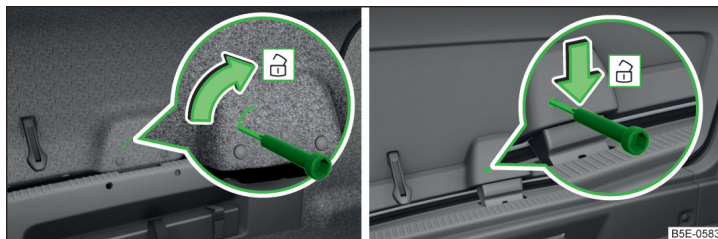
Илл. 329 Отпирание крышки: вариант 1/вариант 2
