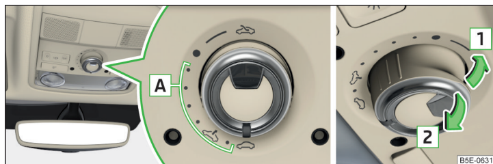
Илл. 54 Управление подъёмно-сдвижным люком
