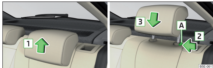
Илл. 83 Регулировка высоты заднего подголовника
