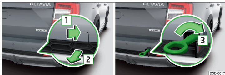
Илл. 324 Снятие крышки/установка буксирной проушины: вариант 2
