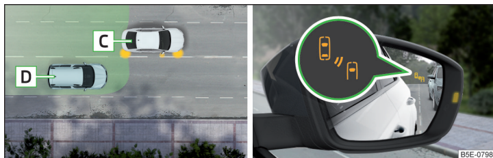
Илл. 246 Дорожная ситуация/индикатор в правом наружном зеркале сигнализирует о ситуации
