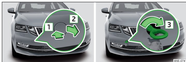
Илл. 322 Снятие крышки/установка буксирной проушины
