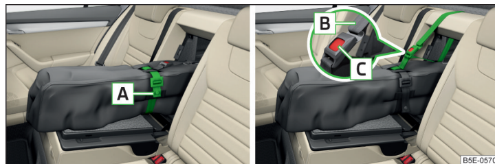
Илл. 106 Затягивание ремня/фиксация чехла для лыж
