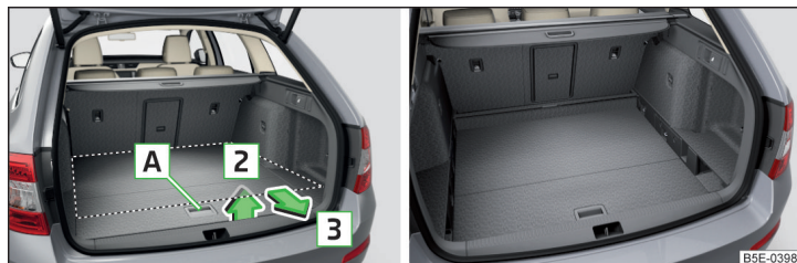
Илл. 134 Перевод трансформируемого пола в нижнее положение/трансформируемый пол в нижнем положении
