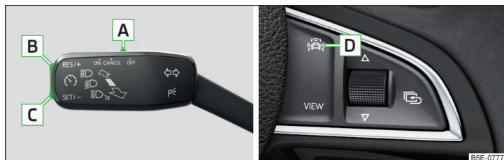
Илл. 264 Органы управления ограничителя скорости: подрулевой переключатель/многофункциональное рулевое колесо
