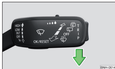
Илл. 331 Установка поводков стеклоочистителя в сервисное положение
