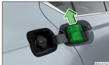
Илл. 293 Местонахождение скребка, снятие скребка
