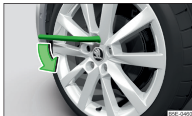
Илл. 316 Отворачивание колёсных болтов
