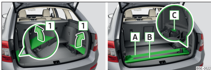
Илл. 134 Снятие боковых накладок багажного отсека / хранение снятого с крыши багажника
