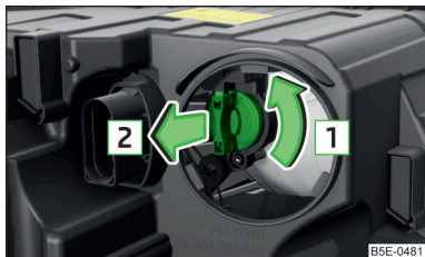
Илл. 245 Лампы накаливания дальнего света, дневных ходовых и габаритных огней
