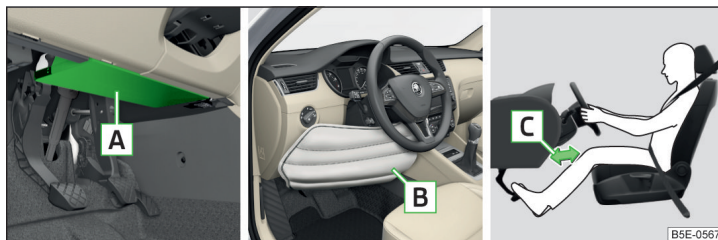
Илл. 10 Место установки подушки безопасности / полностью раскрывшаяся подушка безопасности / безопасное расстояние от ног до передней панели
