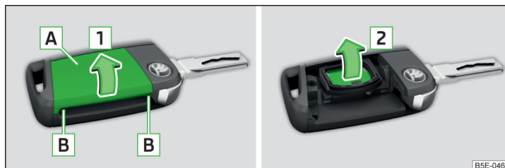
Илл. 230 Снятие крышки / извлечение элемента питания
