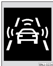
Илл. 175 Пиктограмма на дисплее комбинации приборов: предварительное предупреждение или аварийное торможение при низкой скорости
