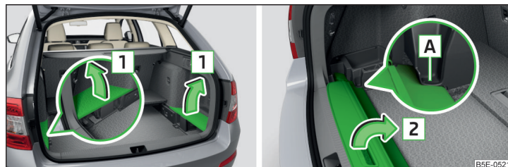
Илл. 121 Снятие боковых накладок багажного отсека / хранение сматывающейся шторки багажного отсека
