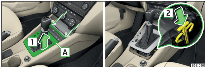
Илл. 235 Аварийная разблокировка рычага селектора
