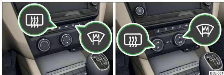
Илл. 65 Клавиши обогрева ветрового и заднего стекла: климатическая установка с ручным управлением, отопитель / Climatronic
