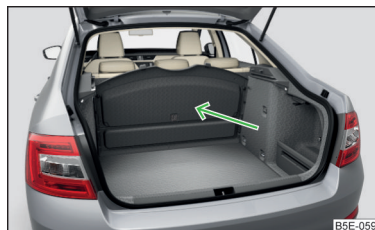
Илл. 118 Снятие полки багажного отсека
