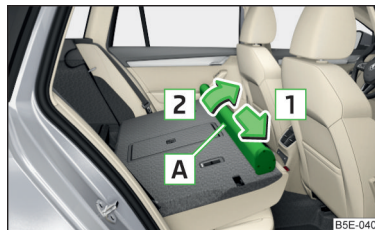
Илл. 132 Снятие корпуса разделительной сетки
