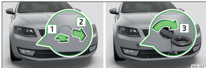
Илл. 227 Снятие крышки / установка буксирной проушины
