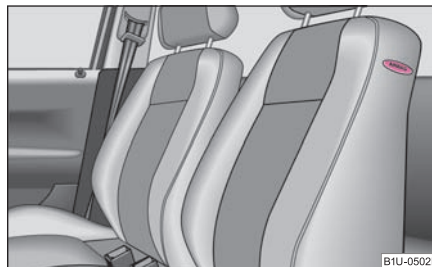
Изобр. 126 Местонахождение боковых надувных подушек безопасности в сиденье водителя
