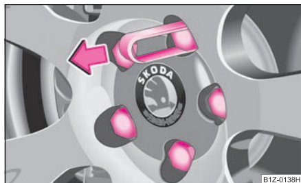
Изобр. 167 Снятие колпака болта крепления колеса
