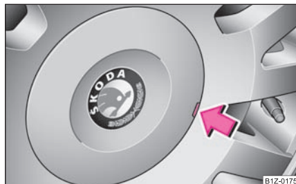
Изобр. 168 Снятие декоративного колпака колес из легкого сплава
