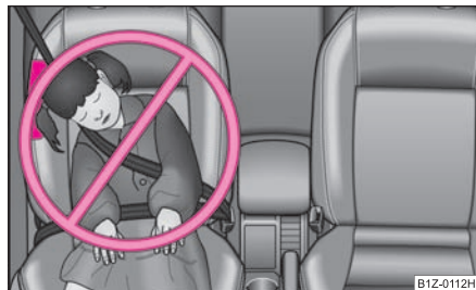
Изобр. 131 Неправильно пристегнутый ребенок, находящийся на сиденье в положении, в котором он подвергается опасности со стороны боковой надувной подушки безопасности
