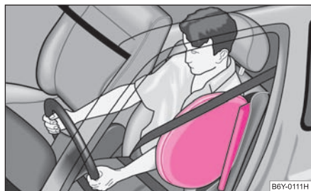
Изобр. 127 Раздутые боковые подушки безопасности, заполненные газом
