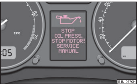
Изобр. 29 Информационный дисплей: низкое давление масла
