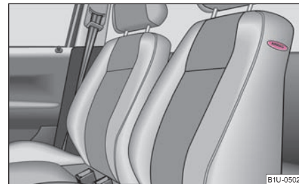
Изобр. 121 Местоположение боковых надувных подушек безопасности в сиденье водителя
