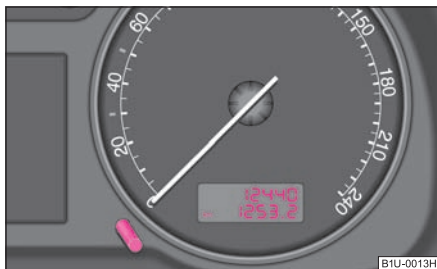
Изобр. 19 Панель приборов: Счетчик пробега
