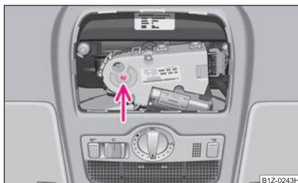
Изобр. 39 Вырез на потолке: Аварийное управление
