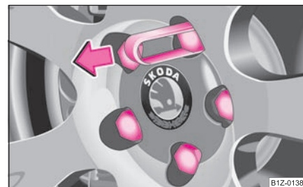
Изобр. 161 Снятие колпака болта крепления колеса
