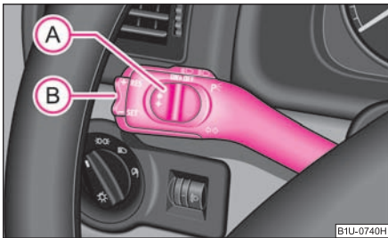
Изобр. 104 Ручка управления: Нажимная кнопка и выключатель устройства регулирования скорости
