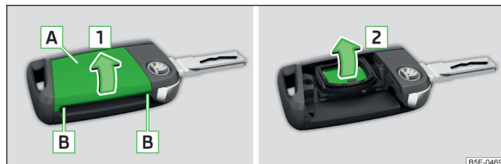
Илл. 234 Открытие крышки/извлечение элемента питания
