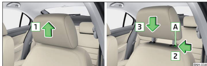
Илл. 61 Регулировка высоты подголовника
