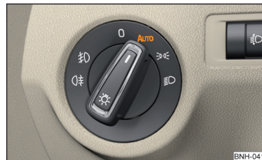
Илл. 45 Переключатель освещения: Положение AUTO
