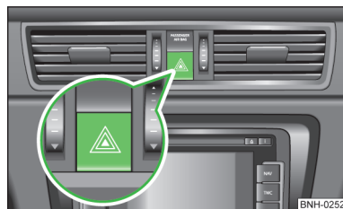
Илл. 24 Кнопка аварийной световой сигнализации.
