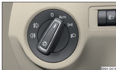
Илл. 41 Переключатель освещения: положение AUTO
