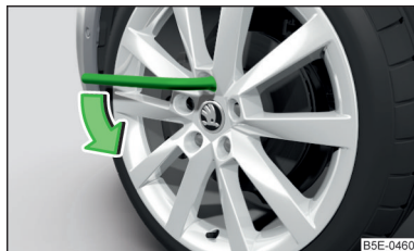
Илл. 133 Замена колёс: отворачивание колёсных болтов
