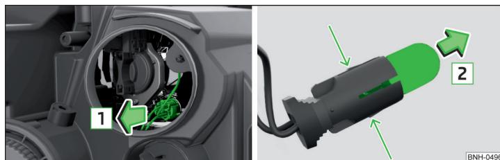
Илл. 156 Замена лампы габаритных огней
