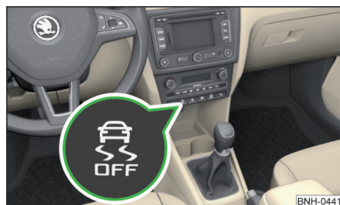
Илл. 97 Кнопка системы ESC: деактивация/активация ASR
