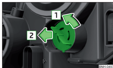
Илл. 157 Замена лампы накаливания в переднем указателе поворота
