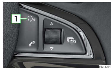
Илл. 88 Многофункциональное рулевое колесо: голосовое управление
