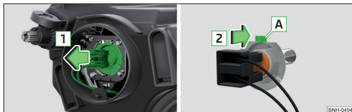
Илл. 154 Замена лампы накаливания ближнего света
