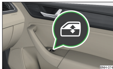
Илл. 42 Клавиша стеклоподъёмника со стороны переднего пассажира
