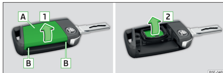
Илл. 234 Открытие крышки/извлечение элемента питания
