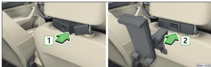
Илл. 86 Установка: адаптер/держатель
