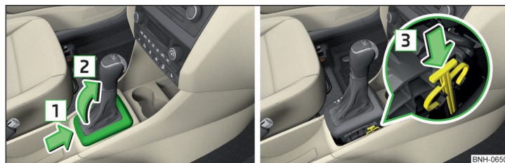
Илл. 238 Снятие крышки / разблокировка рычага селектора
