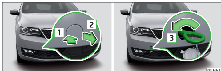
Илл. 232 Снятие крышки / установка буксирной проушины
