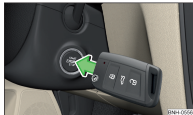
Илл. 166 Запуск двигателя: нажмите кнопку пуска непосредственно ключом
