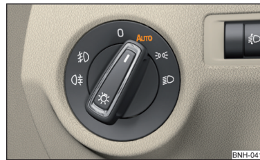
Илл. 45 Переключатель освещения: Положение AUTO
