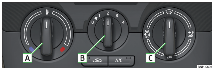
Илл. 100 Органы управления системой отопления, вентиляции и климатической установкой
