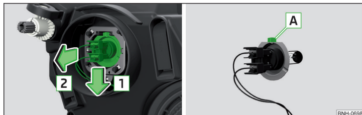
Илл. 251 Замена лампы накаливания ближнего света
