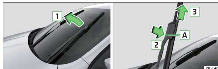
Илл. 240 Замена щётки стеклоочистителя ветрового стекла
