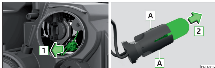
Илл. 250 Замена ламп габаритных огней
