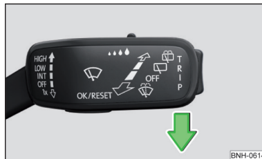
Илл. 239 Установка поводков стеклоочистителя в сервисное положение
