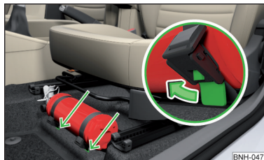
Илл. 221 Отсоединение огнетушителя
